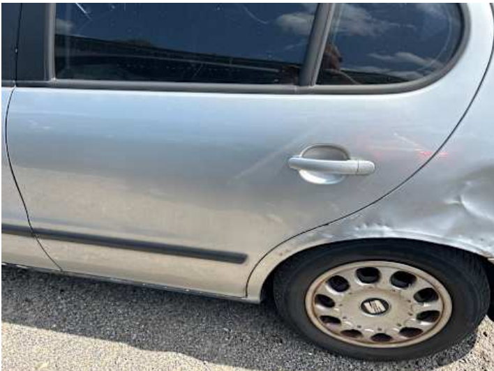
Türe hinten links (Kratzer)
