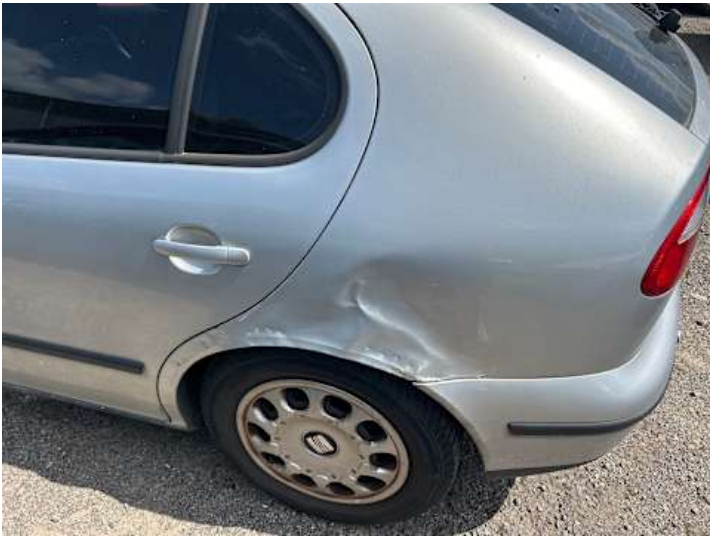
Seitenteil hinten links (Kratzer, Delle)
