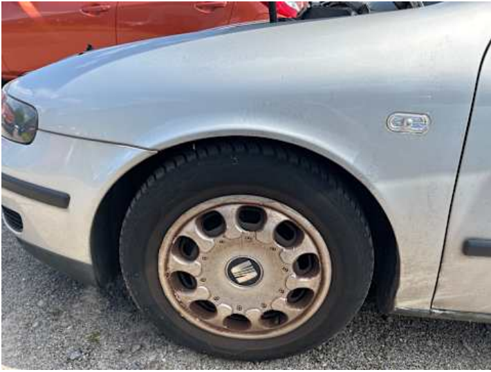
Kotflügel vorne links (Rost)
