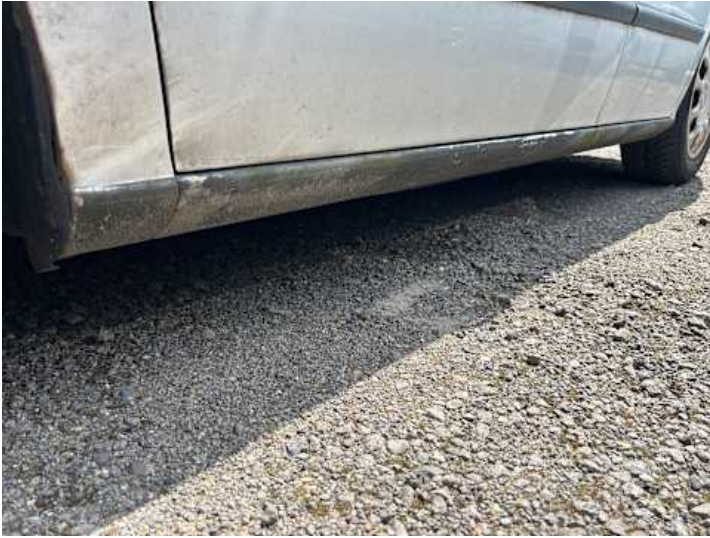
Schweller links (Rost)
