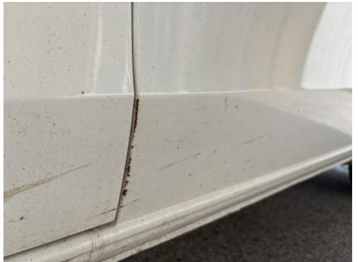
Seitenteil hinten links (Rost)
