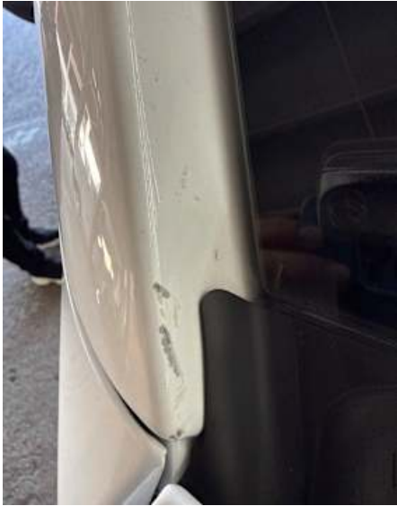
Seitenteil hinten rechts (Kratzer)
