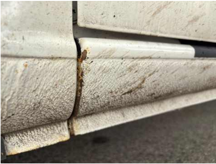
Schweller links (Rost)
