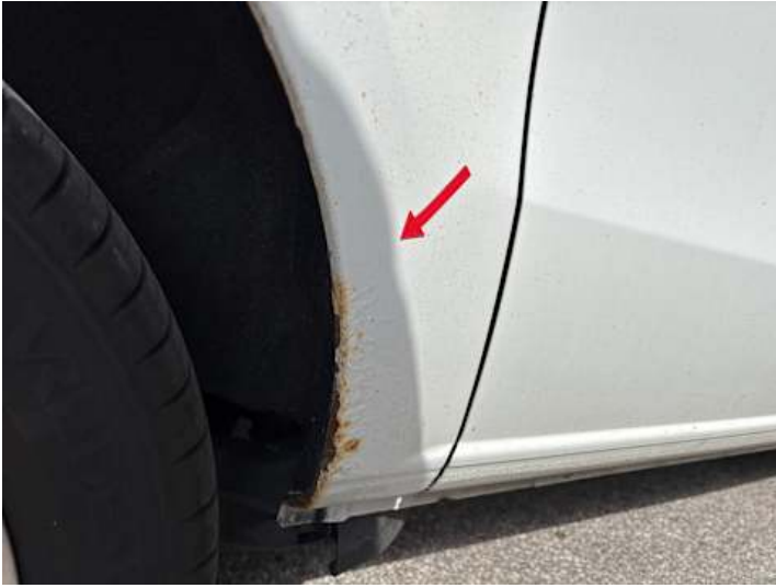
Seitenteil hinten rechts (Rost)
