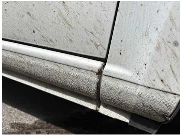
Schweller rechts (Rost)
