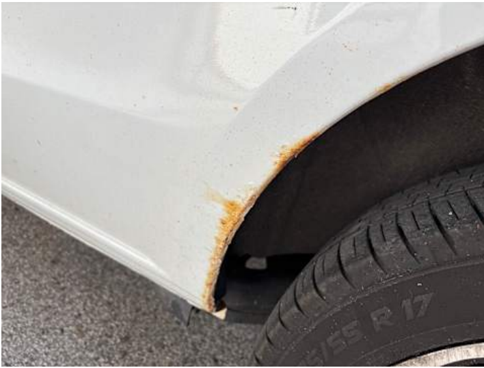
Seitenteil hinten links (Rost)
