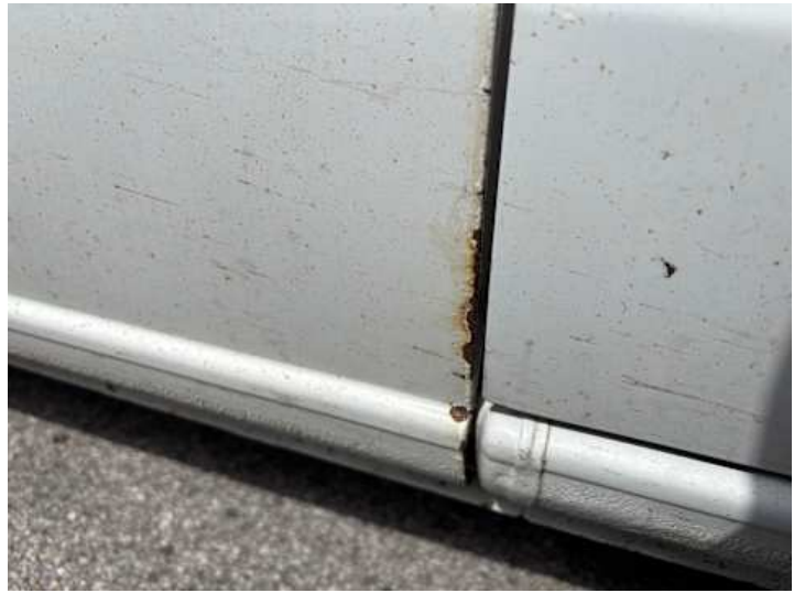
Türe hinten rechts (Rost)
