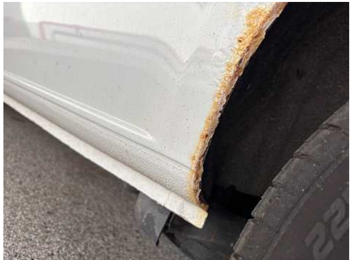
Schweller links (Rost)
