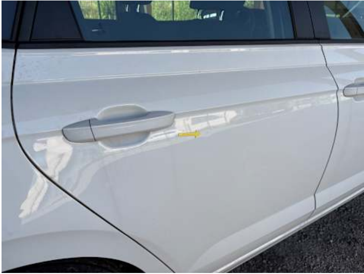
Türe hinten rechts (Delle)
