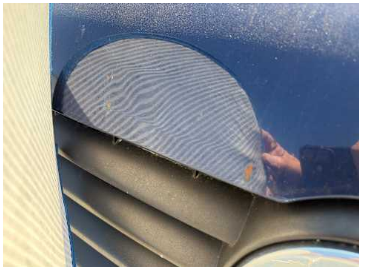
Motorhaube (Delle, Rost, Kratzer)
