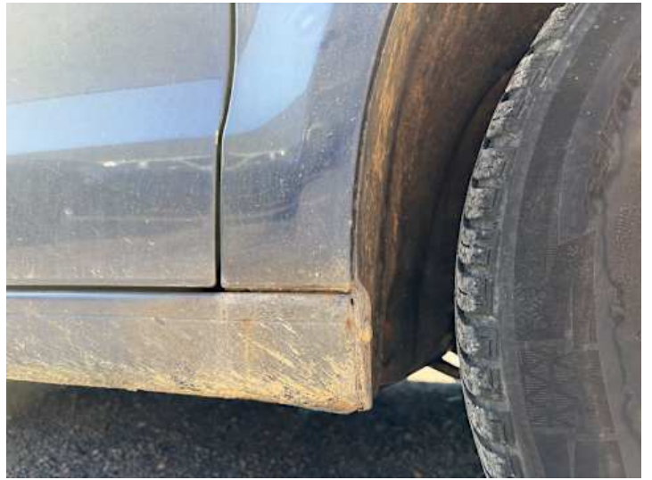
Kotflügel vorne rechts (Lackschaden, Rost)
