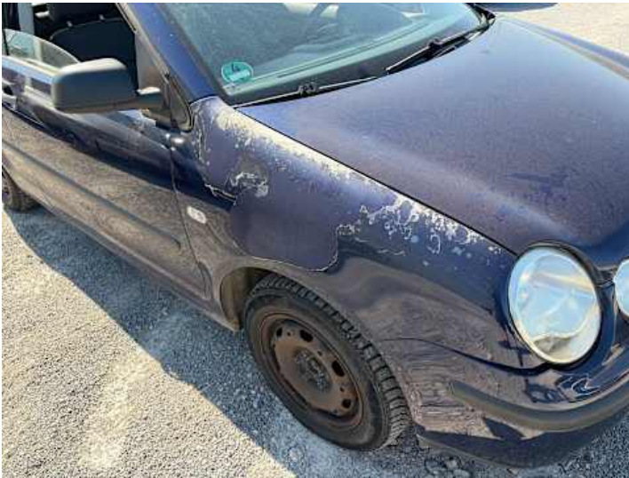
Kotflügel vorne rechts (Lackschaden, Rost)
