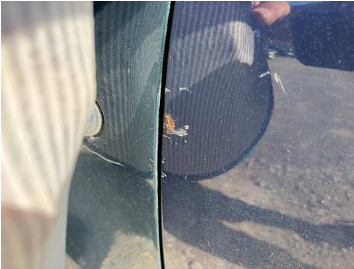
Fahrentür (Rost, Delle)
