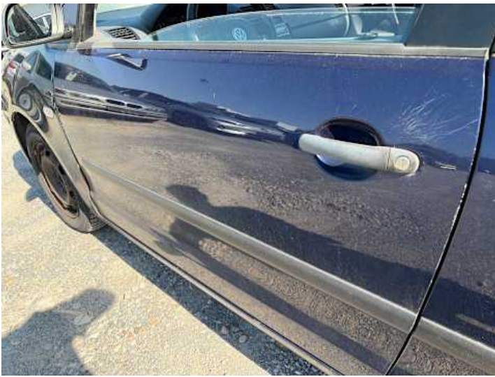
Fahrentür (Kratzer, Delle)
