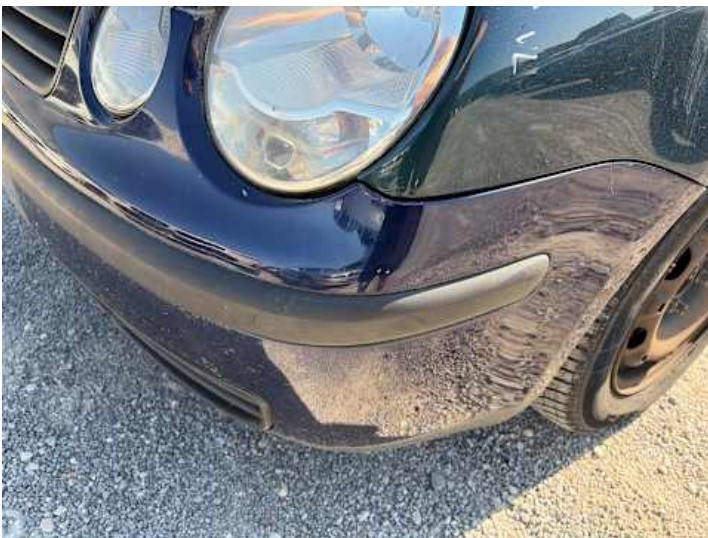
Stoßstange vorne (Riss/Bruch, Kratzer, Spaltmaße ungenau)
