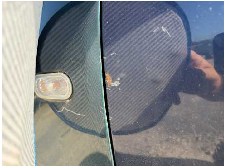
Kotflügel vorne links (Lackschaden, Kratzer, Rost)
