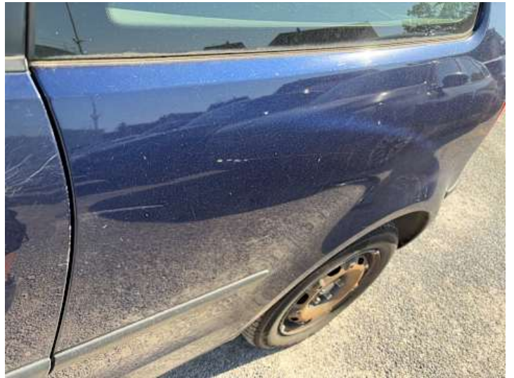
Seitenteil hinten links (Kratzer, Rost)
