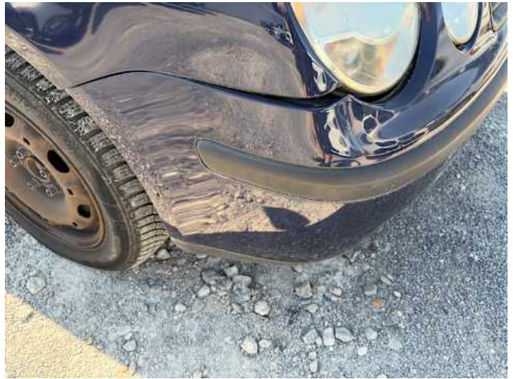
Stoßstange vorne (Riss/Bruch, Kratzer, Spaltmaße ungenau)
