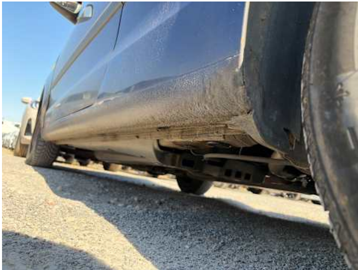
Schweller links (Rost)
