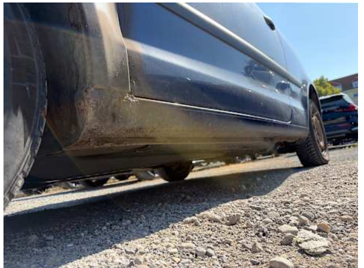
Schweller links (Rost)
