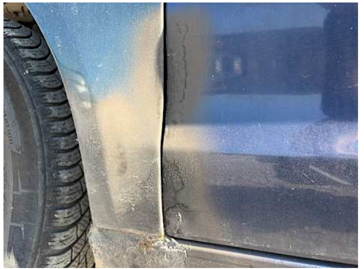
Fahrentür (Rost, Delle)
