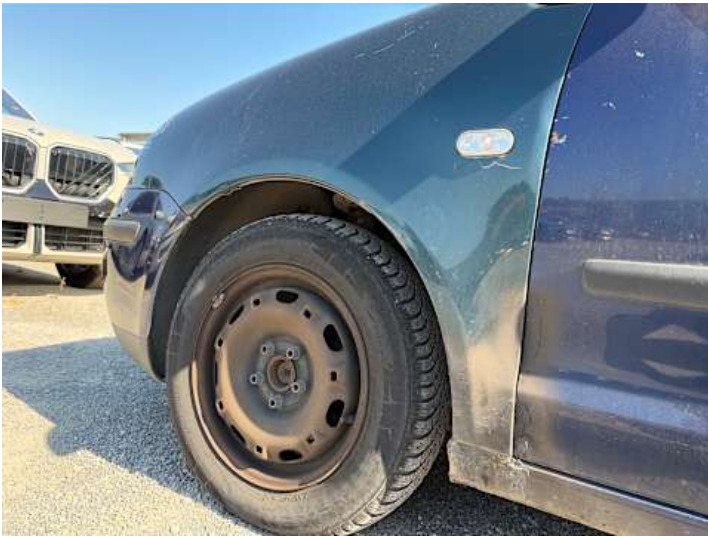
Kotflügel vorne links (Lackschaden, Kratzer, Rost)
