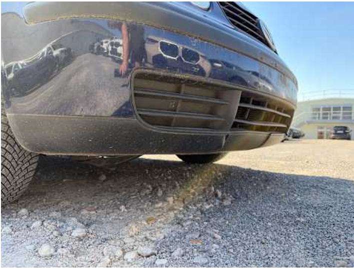
Stoßstange vorne (Riss/Bruch, Kratzer, Spaltmaße ungenau)
