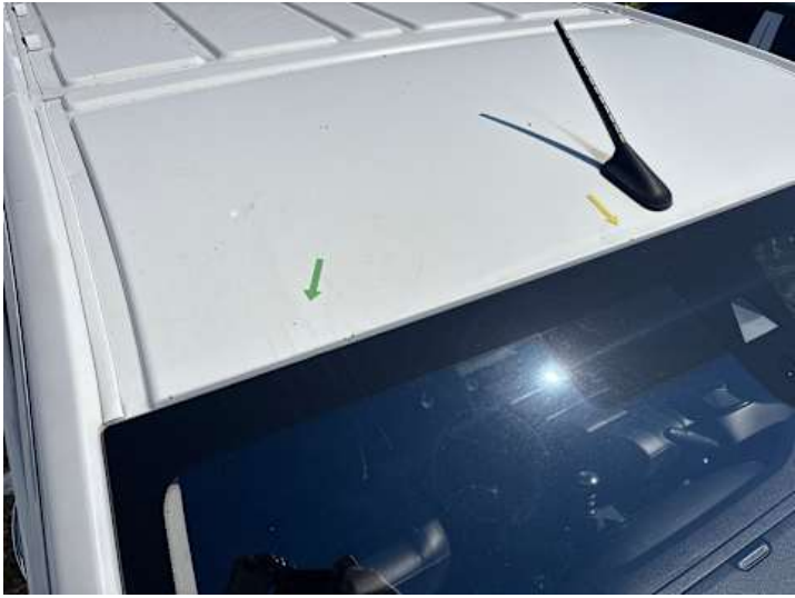
Dach (Lackschaden, Steinschlag)
