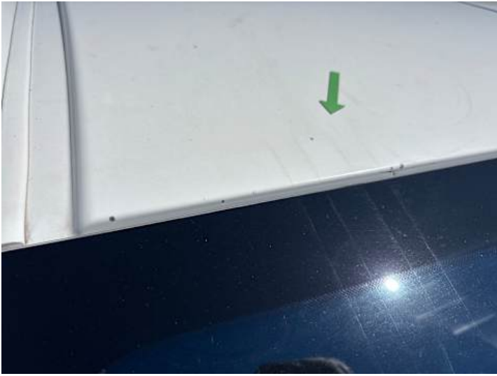
Dach (Lackschaden, Steinschlag)
