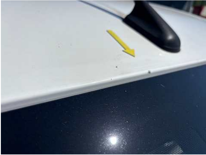
Dach (Lackschaden, Steinschlag)
