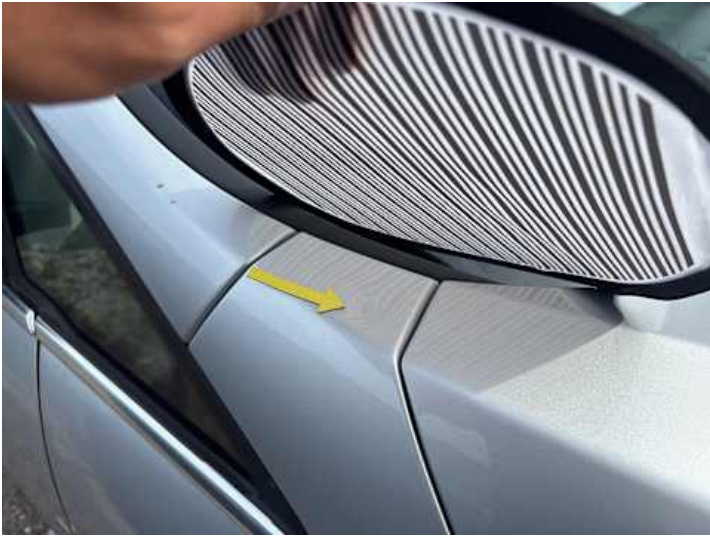
Kotflügel vorne rechts (Delle)
