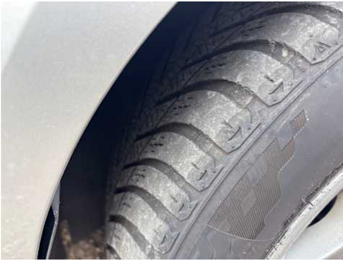
Rad (Ungleichmäßig abgefahren)
