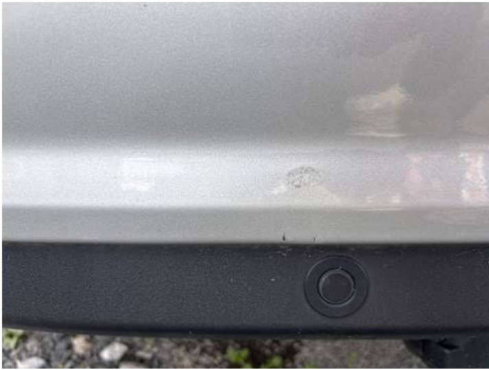
Stoßstange hinten (Spaltmaße ungenau, Kratzer, Lackschaden)
