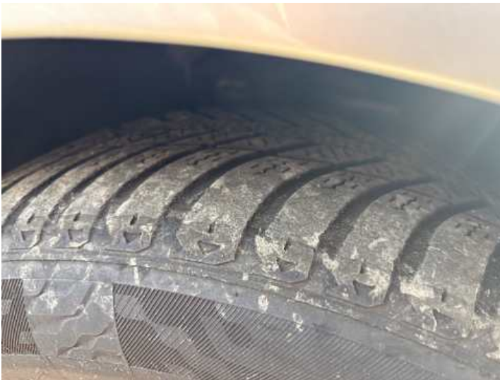
Rad (Ungleichmäßig abgefahren, Kerben, Kratzer)
