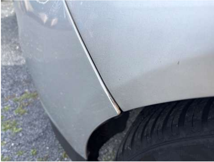
Stoßstange hinten (Spaltmaße ungenau, Kratzer, Lackschaden)
