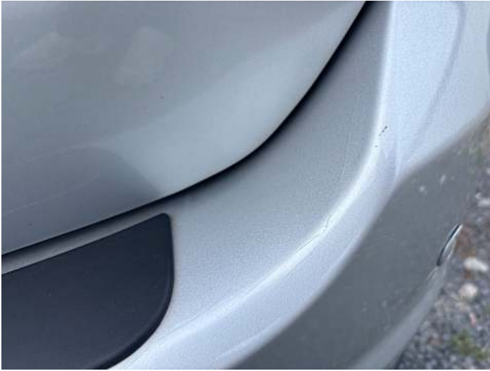
Stoßstange hinten (Spaltmaße ungenau, Kratzer, Lackschaden)
