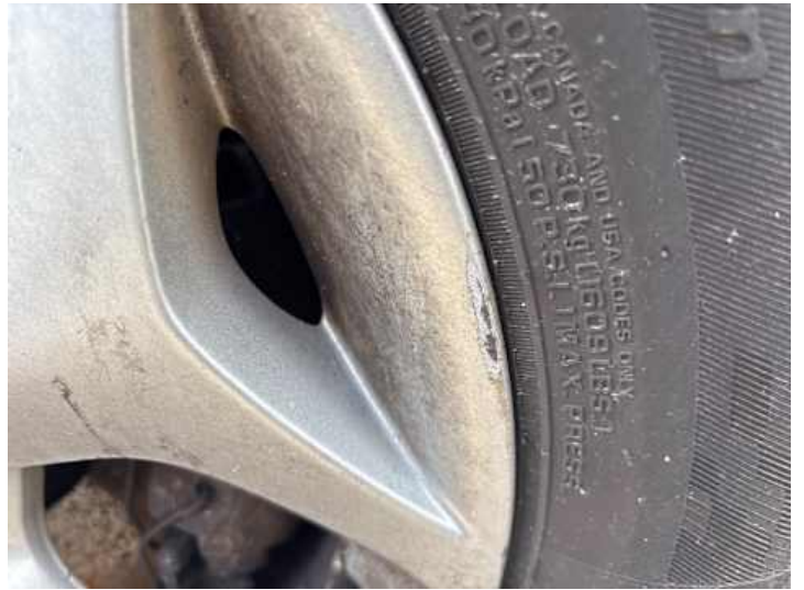
Rad (Ungleichmäßig abgefahren, Kerben, Kratzer)
