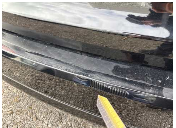
Stoßstange hinten (Lackschaden, Verformung)
