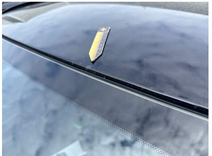
Dach (Rost, Steinschlag)
