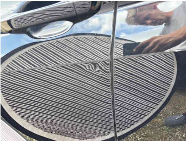
Fahrtür (Delle, Kratzer)
