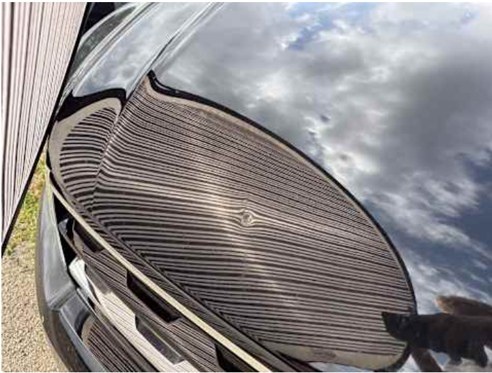
Motorhaube (Delle, Kratzer)
