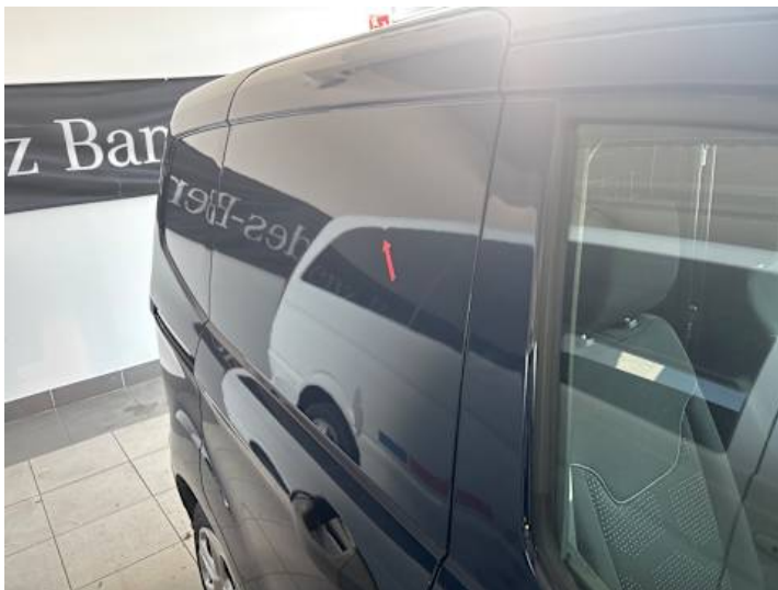
Türe hinten rechts (Verformung)
