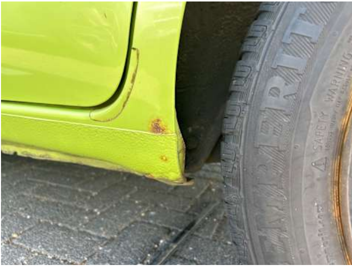
Schweller links (Rost)
