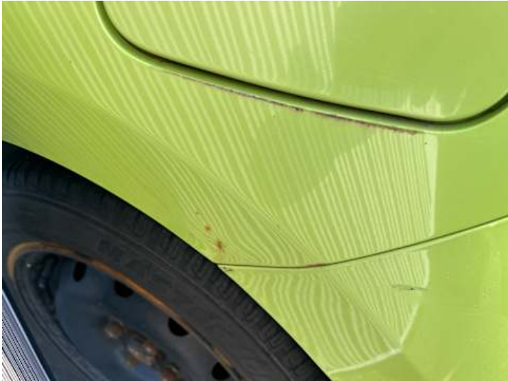
Seitenteil hinten links (Rost, Delle)
