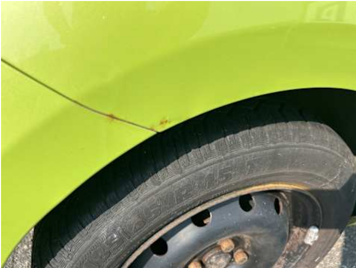
Seitenteil hinten rechts (Rost)
