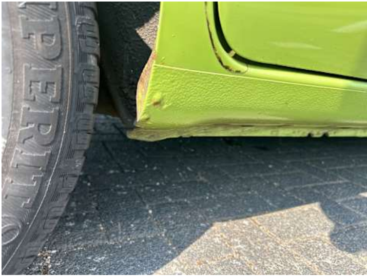
Schweller rechts (Rost)
