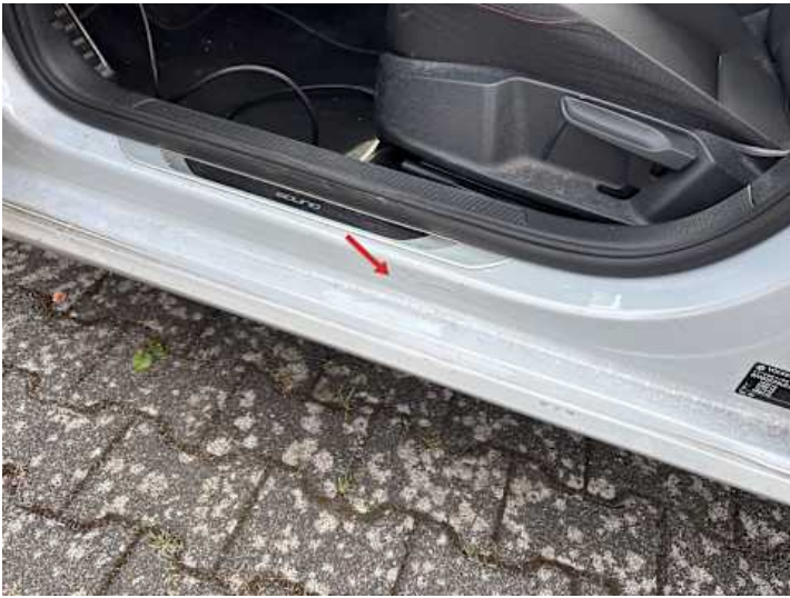
Schweller links (Kratzer)
