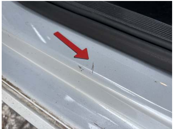
Schweller links (Kratzer)
