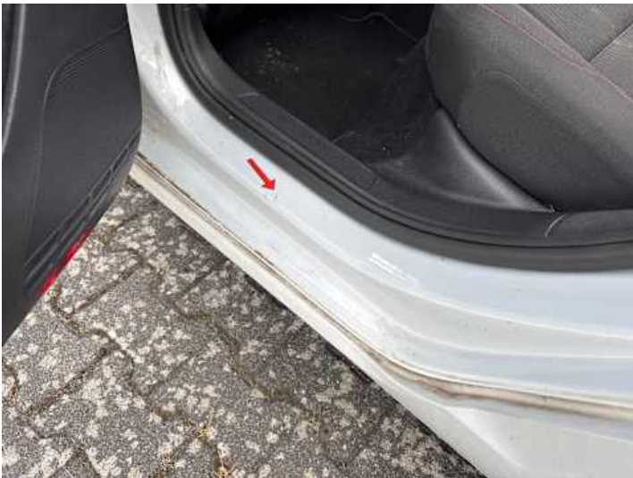
Schweller links (Kratzer)
