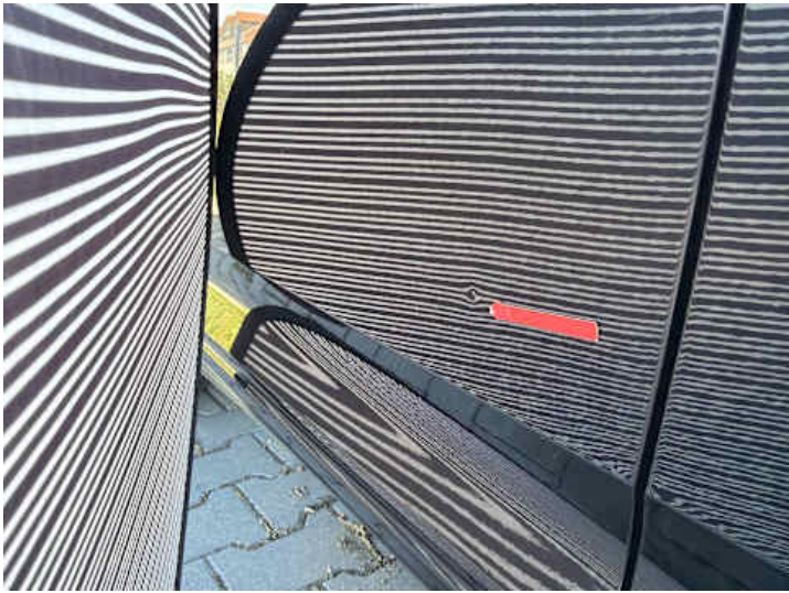
Türe hinten rechts (Delle)
