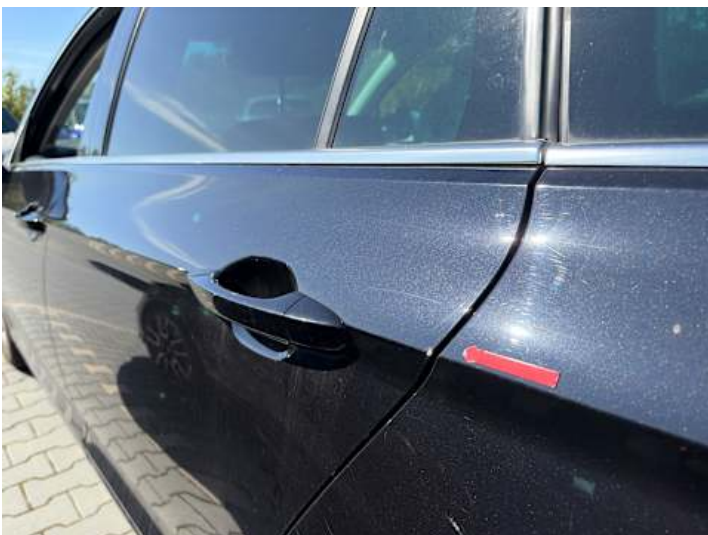
Türe hinten links (Lackschaden)
