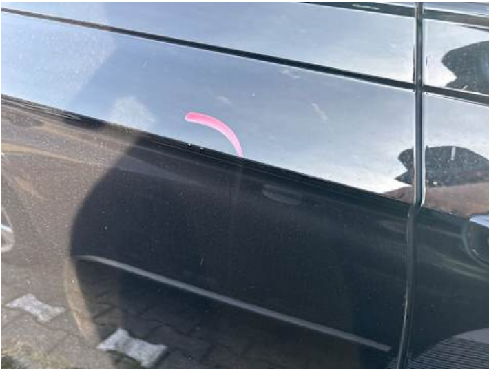
Türe hinten rechts (Delle, Steinschlag)
