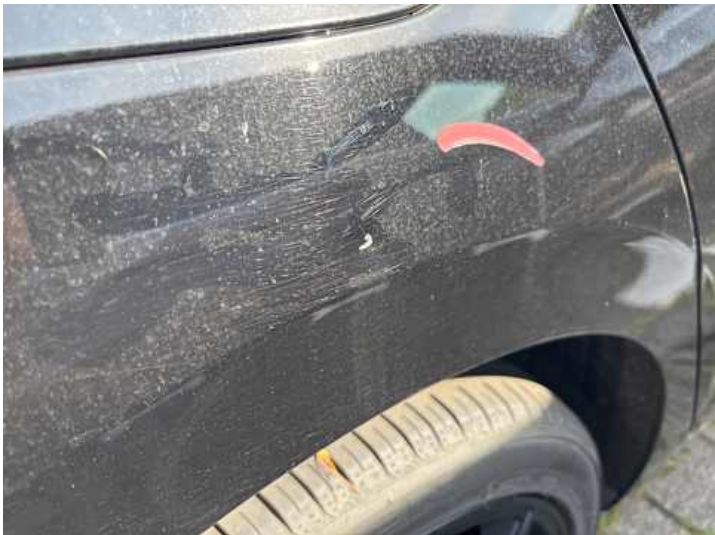
Seitenteil hinten rechts (Lackschaden)
