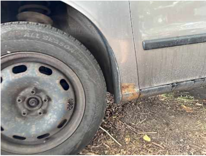
Schweller links (Rost)
