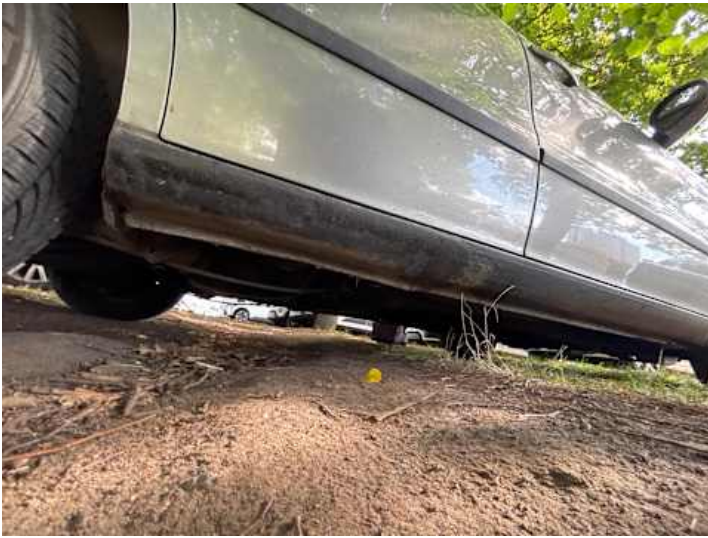
Schweller rechts (Rost, Unsachgemäß instand gesetzt)
