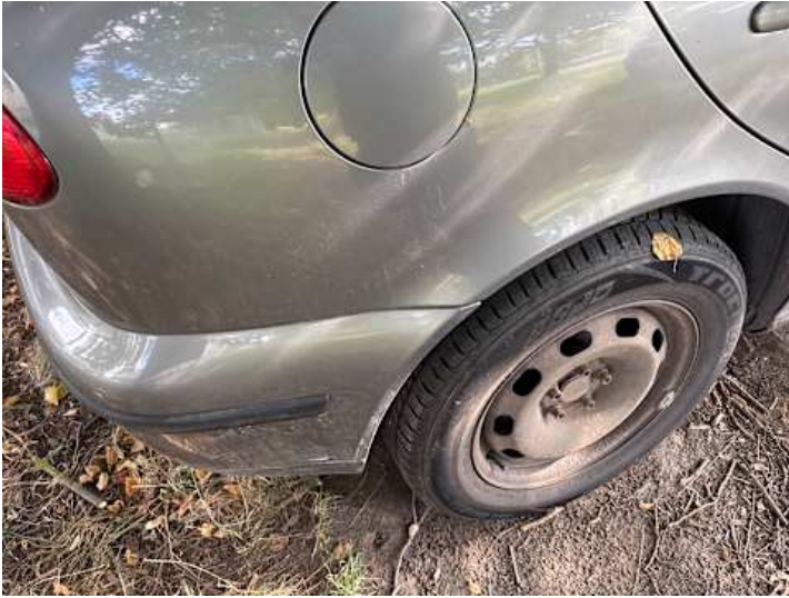
Stoßstange hinten (Spaltmaße ungenau)
