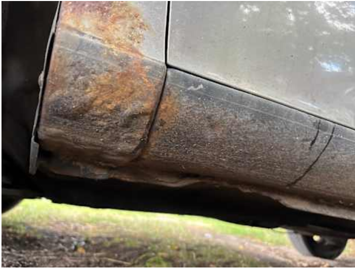
Schweller links (Rost)
