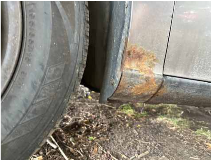
Kotflügel vorne links (Rost)
