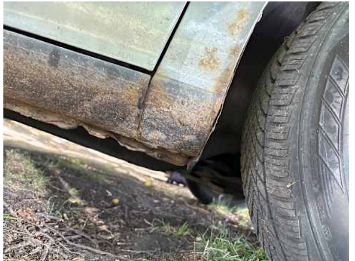
Kotflügel vorne rechts (Rost)
