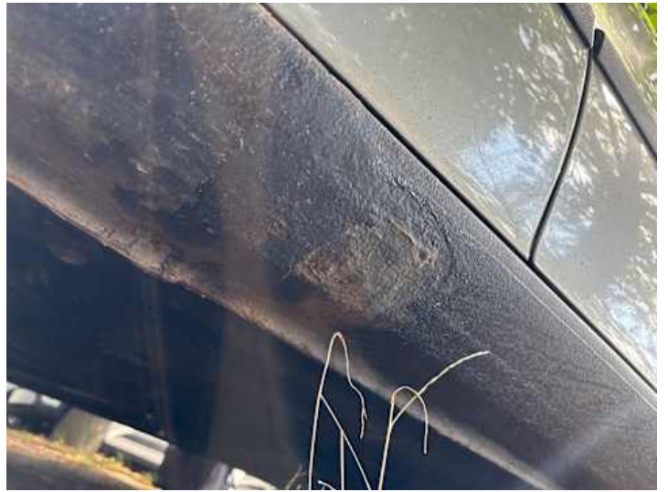
Schweller rechts (Rost, Unsachgemäß instand gesetzt)
