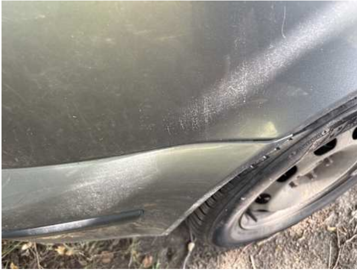
Stoßstange hinten (Spaltmaße ungenau)
