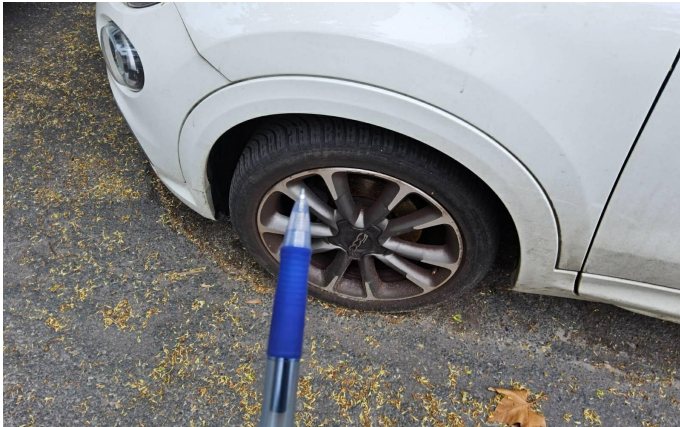
Bild 11: Außen, Felge vorne links, zerkratzt, erneuern
