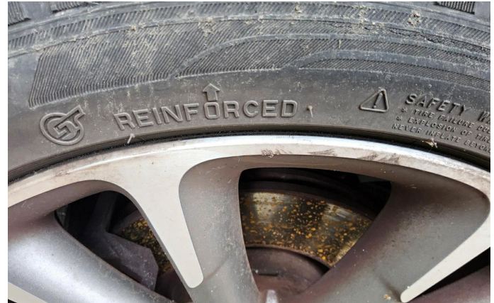
Bild 12: Außen, Felge vorne links, zerkratzt, erneuern
