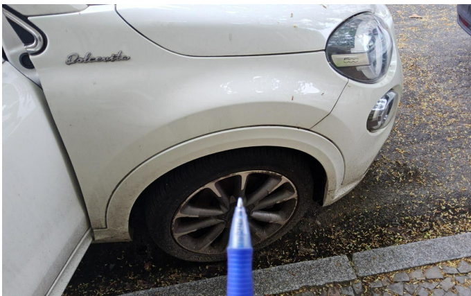
Bild 7: Außen, Felge vorne rechts, zerkratzt, erneuern
