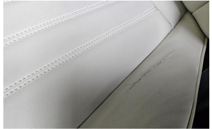
Bild 2: Innen, Sitz vorne links - Sitzbezug, gerissen, erneuern
