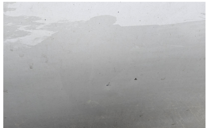
Bild 14: Außen, Tür hinten links - Lackierung, verschrämmt, auslegen und polieren
