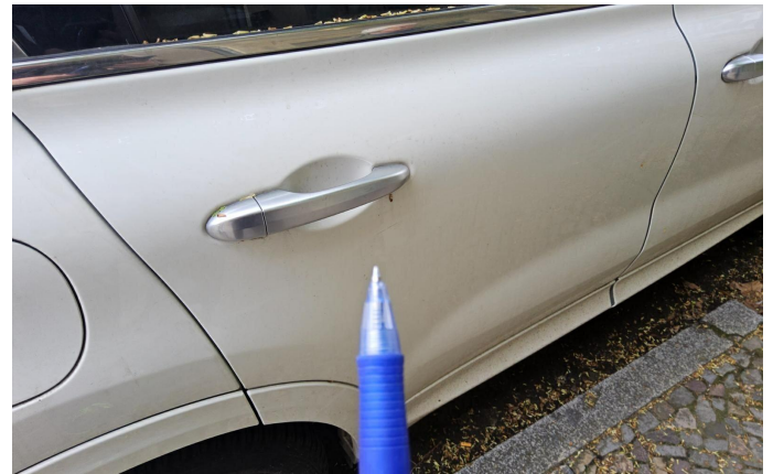
Bild 26: Außen, Tür hinten rechts - Lackierung, verschrammt, polieren
