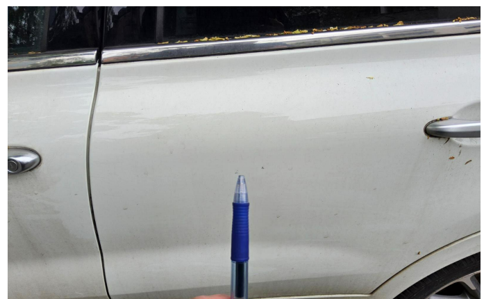
Bild 16: Außen, Tür hinten links - Lackierung, verschrämmt, auslegen und polieren
