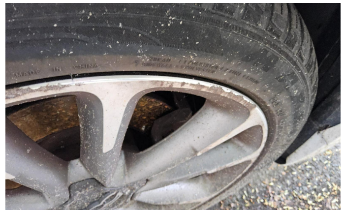
Bild 8: Außen, Felge vorne rechts, zerkratzt, erneuern
