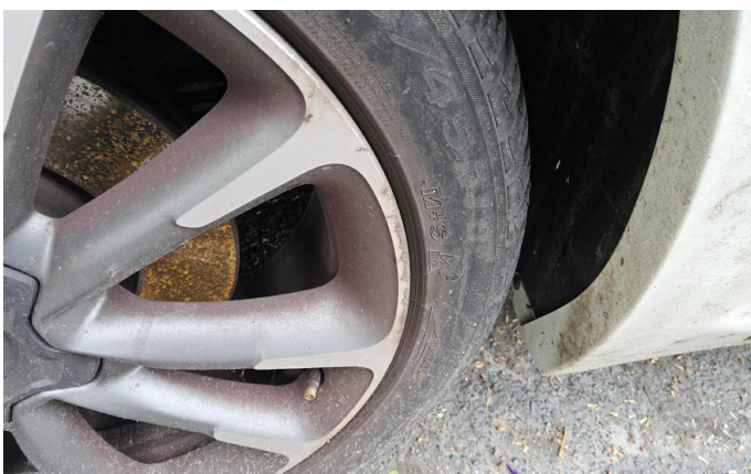
Bild 15: Außen, Felge hinten rechts, zerkratzt, erneuern
