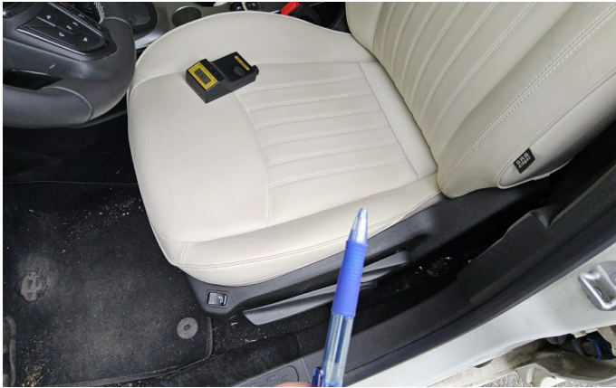
Bild 1: Innen, Sitz vorne links - Sitzbezug, gerissen, erneuern
