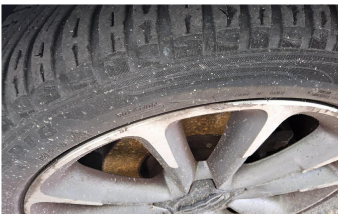
Bild 9: Außen, Felge vorne rechts, zerkratzt, erneuern
