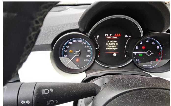
Bild 20: Technik, Elektrik - Motorkontrollleuchte aktiv, MKL, prüfen und Befund festlegen, Schadenerweiterung möglich
