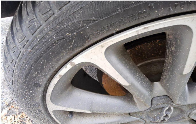
Bild 23: Außen, Felge hinten rechts, zerkratzt, erneuern
