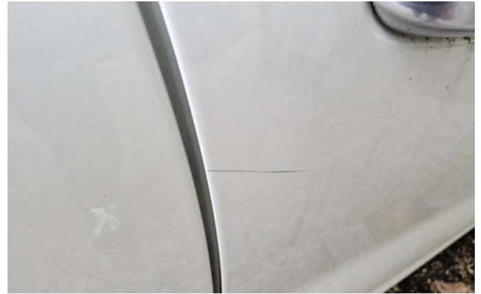
Bild 24: Außen, Tür vorne rechts - Lackierung, verschrammt, polieren
