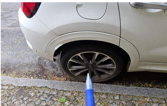
Bild 21: Außen, Felge hinten rechts, zerkratzt, erneuern
