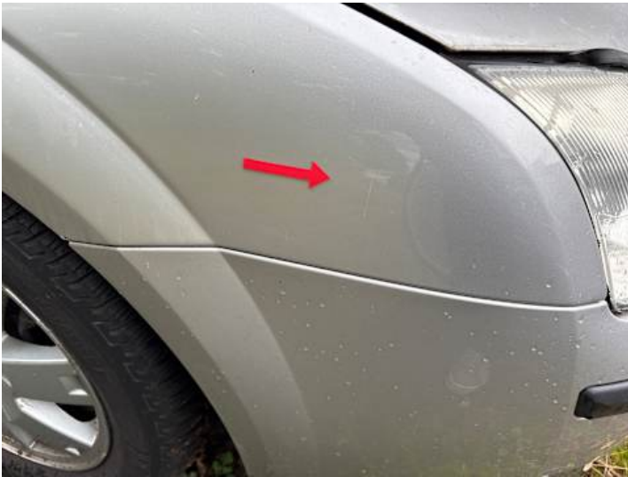
Kotflügel vorne rechts (Kratzer, Delle)
