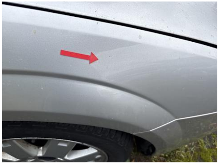
Kotflügel vorne rechts (Kratzer, Delle)
