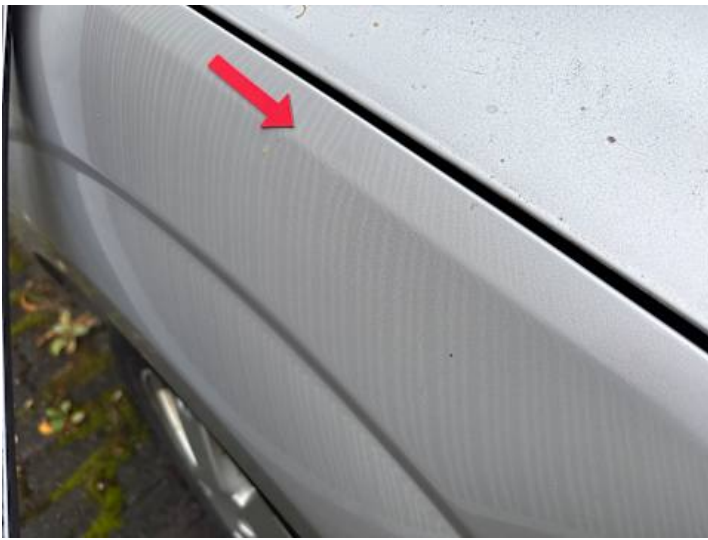
Kotflügel vorne rechts (Kratzer, Delle)
