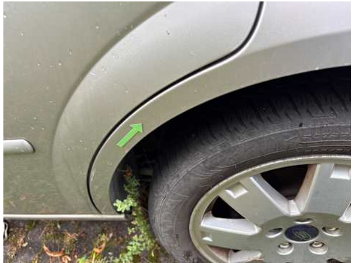
Seitenteil hinten links (Kratzer)
