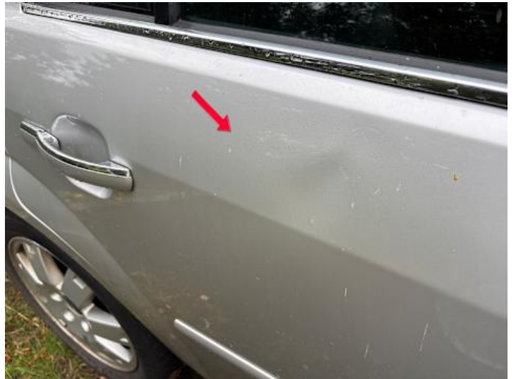
Türe hinten rechts (Verformung)
