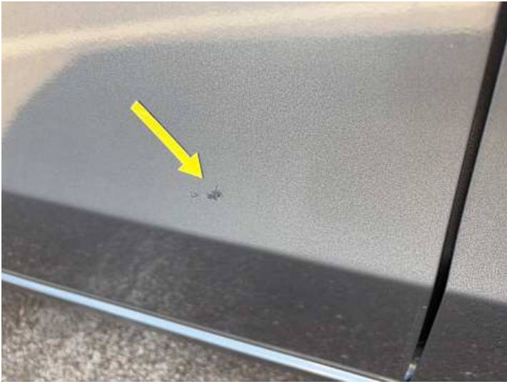
Türe hinten rechts (Kratzer)
