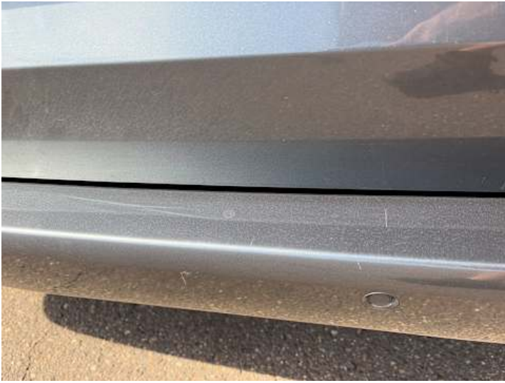
Stoßstange hinten (Kratzer)
