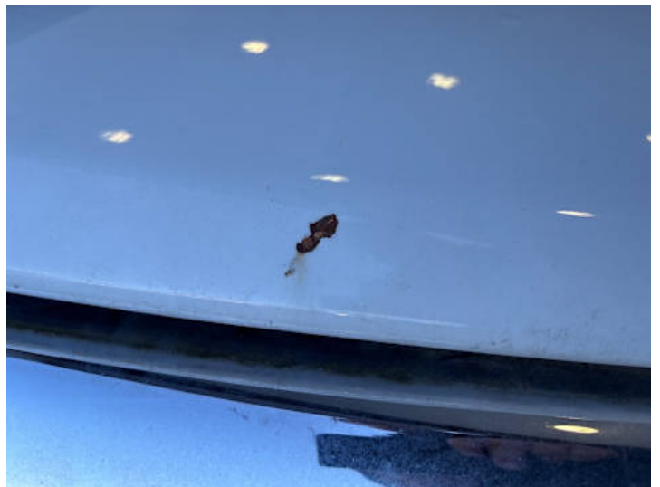
Motorhaube (Rost, Lackschaden)
