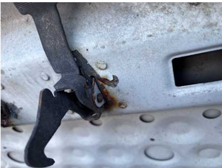
Motorhaube (Rost, Lackschaden)
