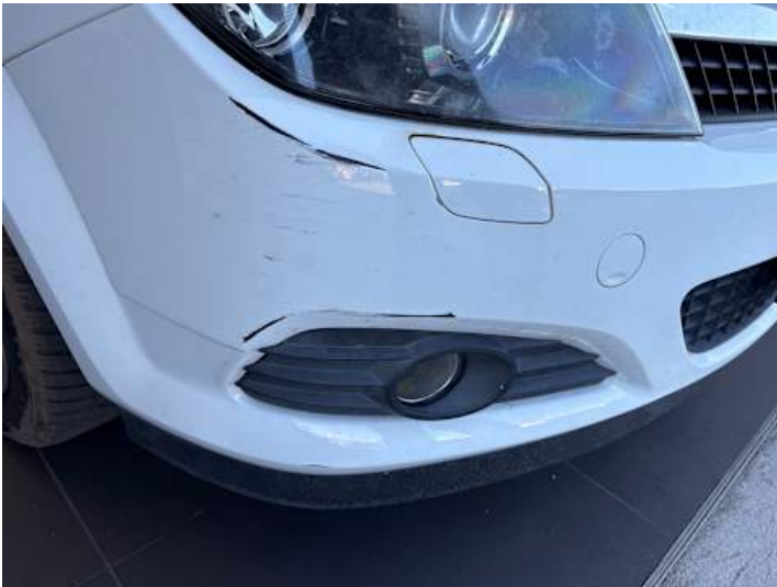
Stoßstange vorne (Kratzer, Lackschaden)
