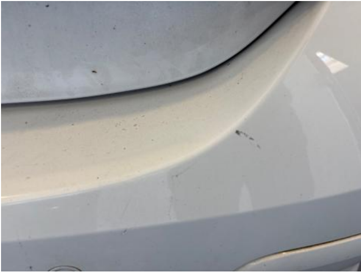
Stoßstange hinten (Kratzer, Lackschaden)
