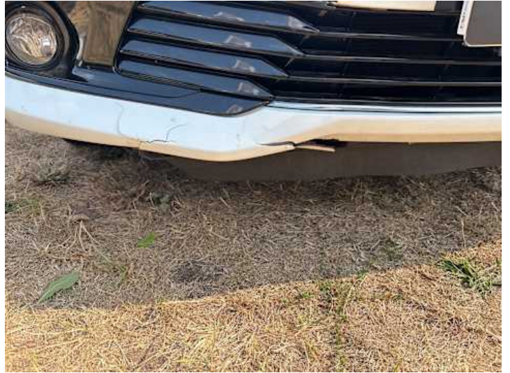
Stoßstange vorne (Riss/Bruch)
