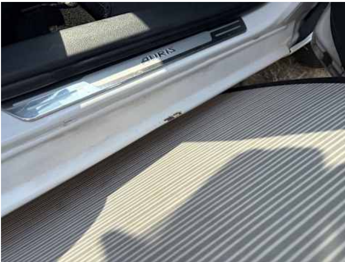
Schweller rechts (Verformung, Kratzer, Rost)
