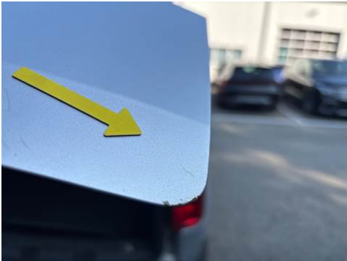
Heckklappe (Rost, Delle)
