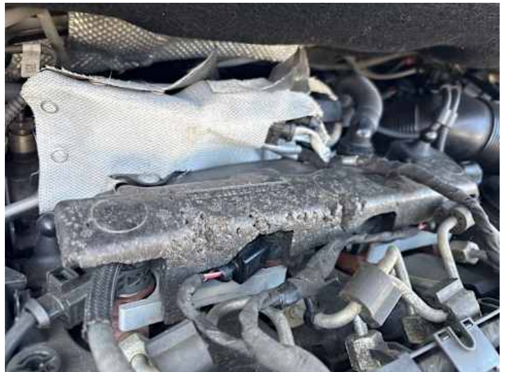
Motorhaube (Anderer Schaden): Tierbiss
