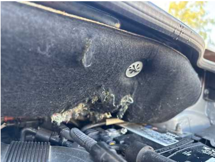
Motorhaube (Anderer Schaden): Tierbiss
