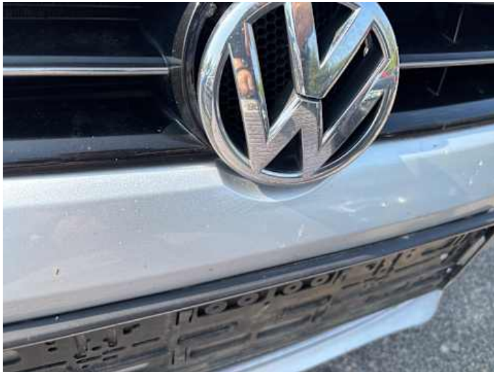
Stoßstange vorne (Riss/Bruch, Lackschaden)
