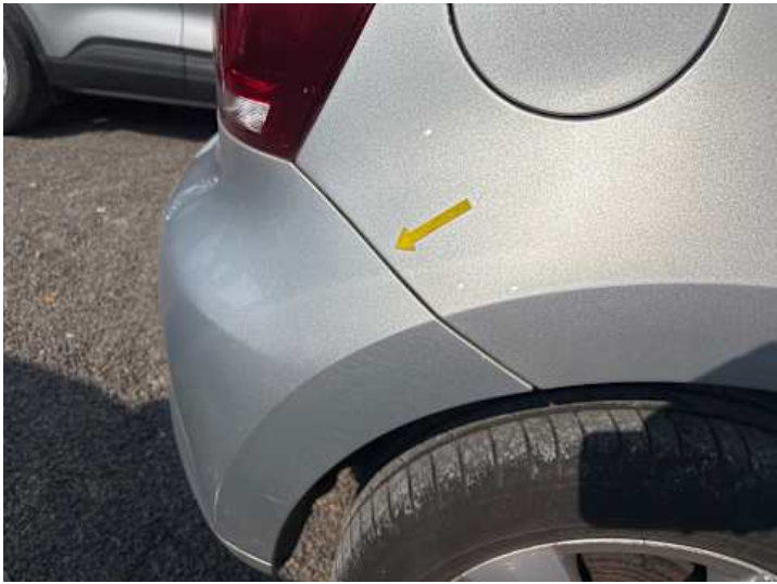
Stoßstange hinten (Unsachgemäß instand gesetzt, Spaltmaße ungenau)
