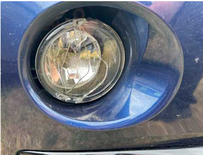
Scheinwerfer (rechts) (Riss/Bruch)
