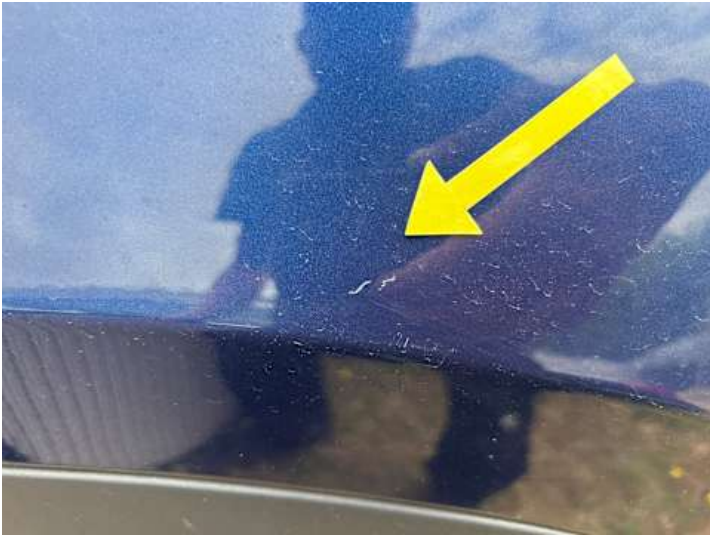
Kotflügel vorne links (Kratzer, Lackschaden)
