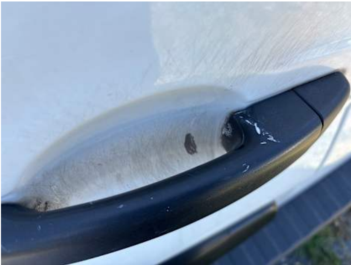
Heckklappe (Kratzer, Lackschaden, Delle, Unsachgemäß instand gesetzt)
