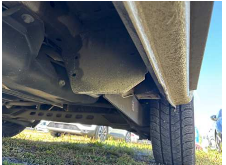
Schweller links (Kratzer, Verformung)
