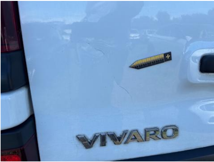
Heckklappe (Kratzer, Lackschaden, Delle, Unsachgemäß instand gesetzt)
