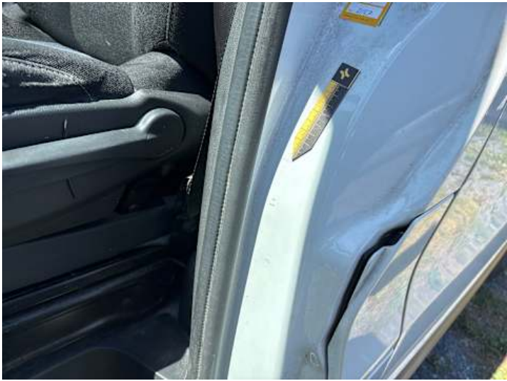
Schweller links (Kratzer, Verformung)
