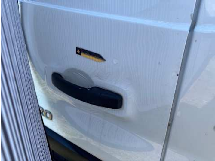
Heckklappe (Kratzer, Lackschaden, Delle, Unsachgemäß instand gesetzt)
