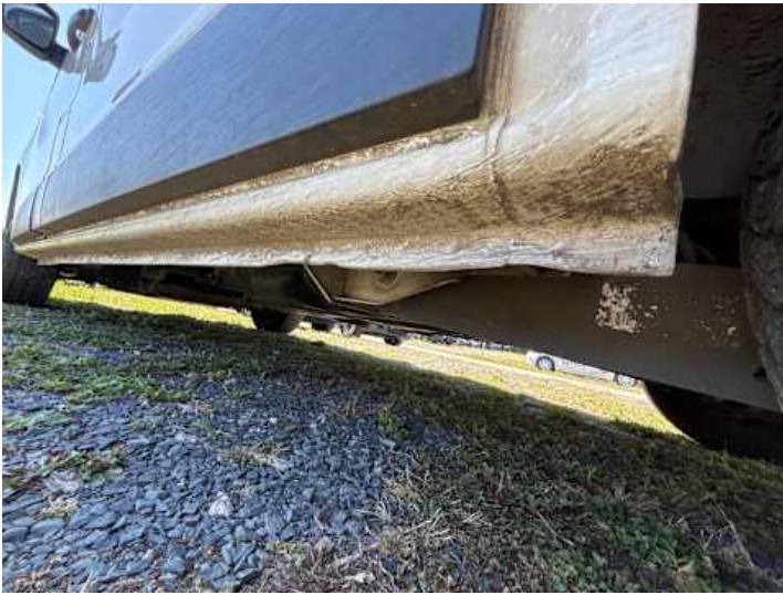
Schweller links (Kratzer, Verformung)
