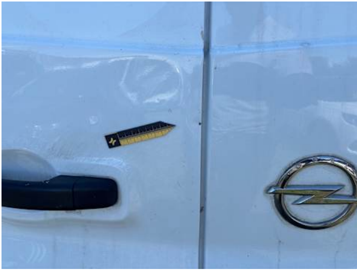
Heckklappe (Kratzer, Lackschaden, Delle, Unsachgemäß instand gesetzt)
