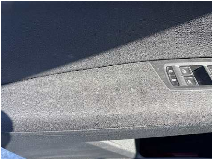
Innenraum (Verschmutzung, Verschleiß)
