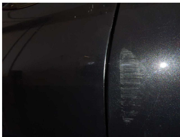
Beschädigung 10: Tür vorn links: Tür - Kratzer - lackieren
