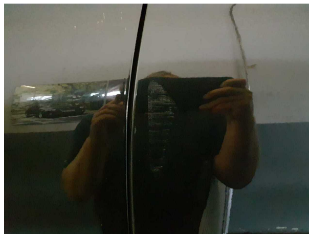
Beschädigung 7: Tür hinten links: Tür - Delle / Lackschaden - sanft instandsetzen
