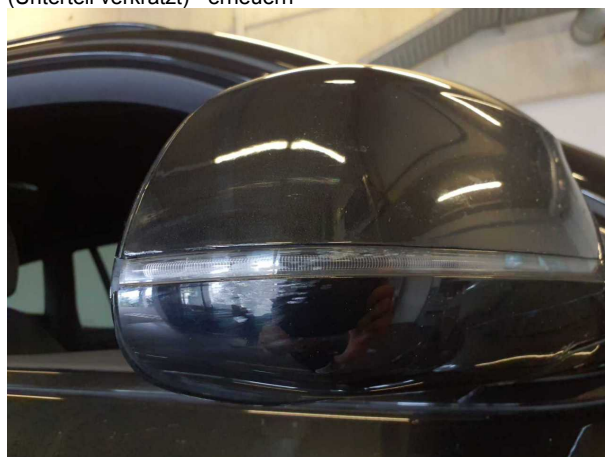
Beschädigung 5: Blinkleuchte: Spiegel rechts - Kratzer - erneuern
