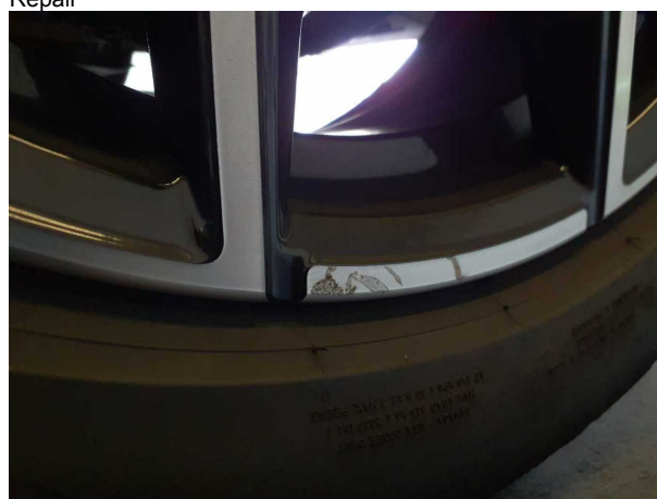
Beschädigung 9: Rad/Reifen: Leichtmetallfelge hinten links - verkratzt / verschürft - Wertminderung
