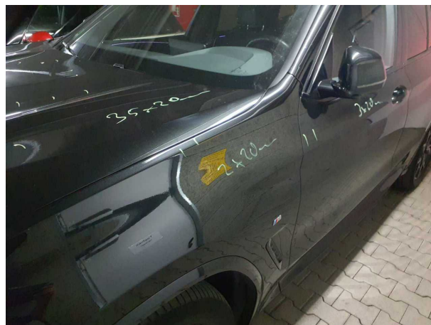
Beschädigung 12: Karosserie: Karosserie (RKÜ liegt vor) - Hagelschaden - instandsetzen lt. Kalkulation
