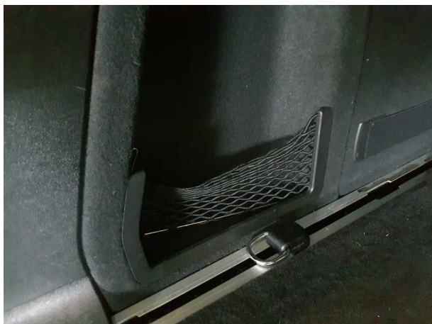
Beschädigung 2: Interieur: Trennnetz - beschädigt - erneuern
