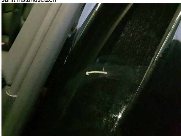
Beschädigung 8: Seitenwand links: Einstieg - Kratzer - Smart Repair
