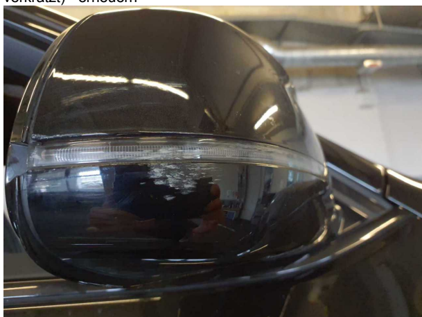
Beschädigung 5: Blinkleuchte: Spiegel rechts - Kratzer - erneuern
