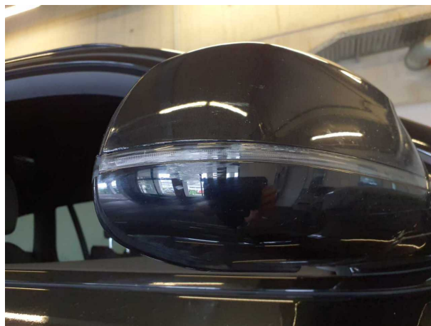
Beschädigung 3: Außenspiegel rechts: Abdeckkappe (Unterteil verkratzt) - erneuern
