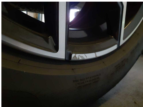
Beschädigung 9: Rad/Reifen: Leichtmetallfelge hinten links - verkratzt / verschürft - Wertminderung
