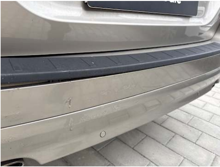
Stoßstange hinten (Kratzer, Lackschaden)
