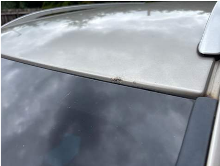
Dach (Lackschaden, Rost)
