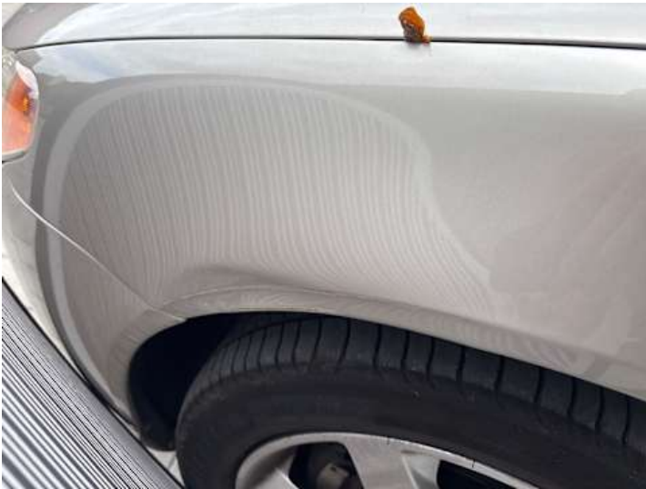
Kotflügel vorne links (Verformung, Lackschaden)
