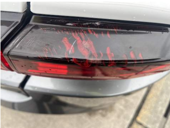
Rücklicht (rechts) (Kratzer, Riss/Bruch)
