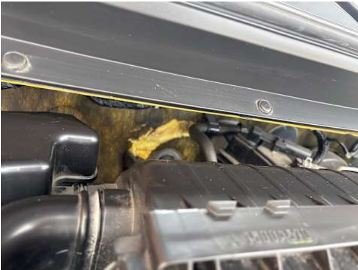
Motorhaube (Anderer Schaden): Dämmung beschädigt
