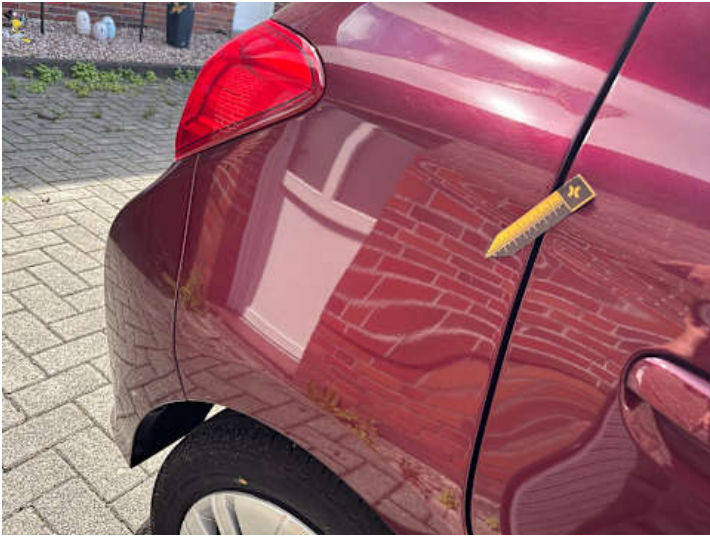
Seitenteil hinten rechts (Kratzer)
