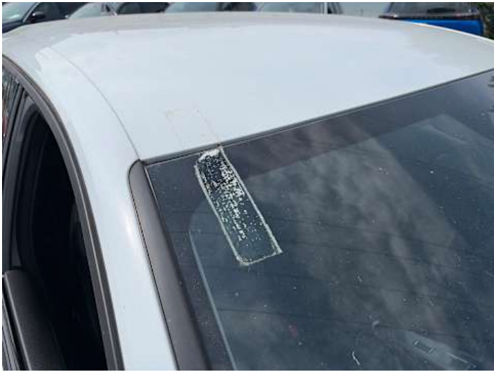
Windschutzscheibe (Anderer Schaden): Klebereste
