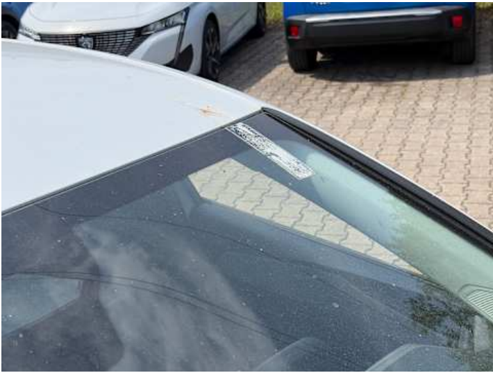
Windschutzscheibe (Anderer Schaden): Klebereste
