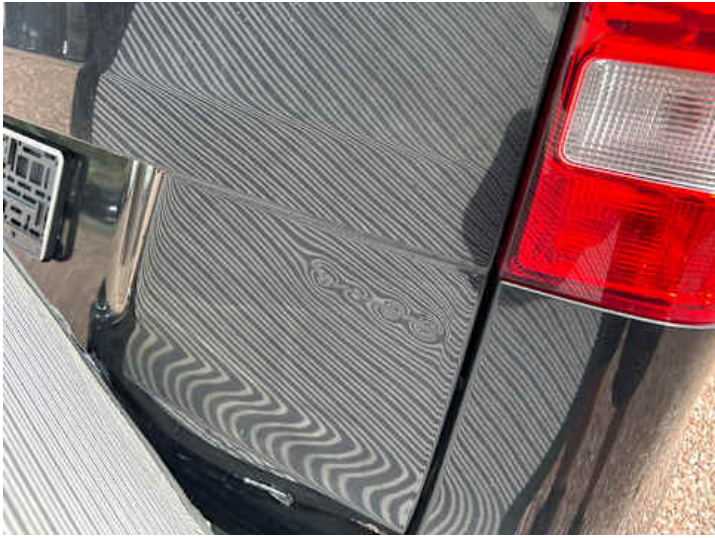
Heckklappe (Delle, Kratzer)
