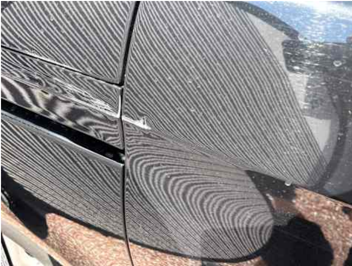
Türe hinten rechts (Kratzer, Delle)
