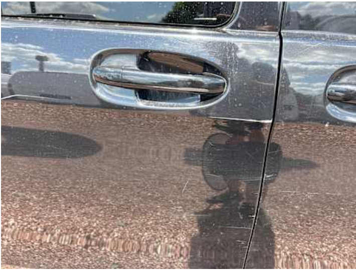
Türe hinten rechts (Kratzer, Delle)
