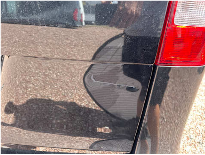
Heckklappe (Delle, Kratzer)
