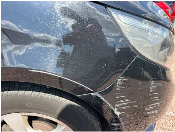
Kotflügel vorne rechts (Kratzer, Lackschaden)
