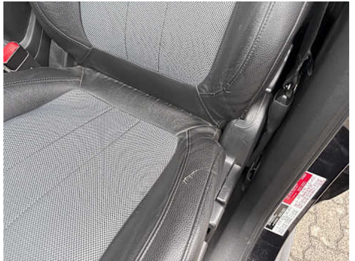
Innenraum (Verschleiß, Riss/Bruch)
