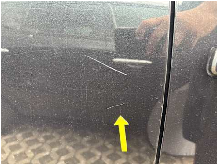
Türe hinten rechts (Lackschaden)
