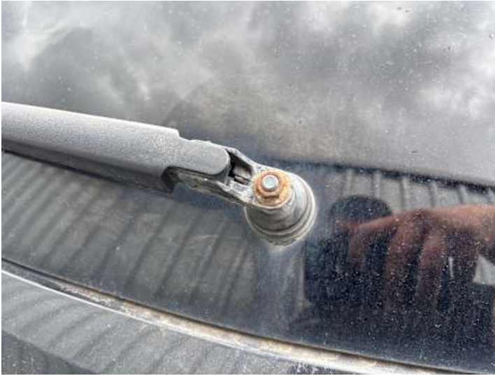
Rückscheibe (Anderer Schaden): Deckel fehlt
