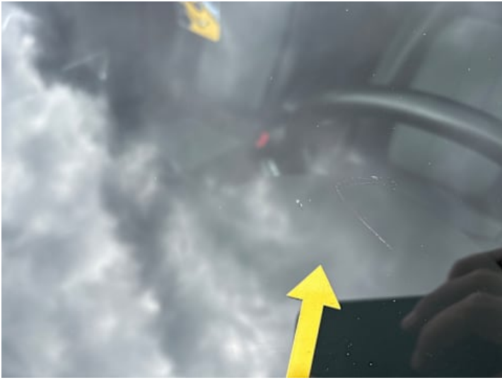
Windschutzscheibe (Steinschlag, Kratzer)
