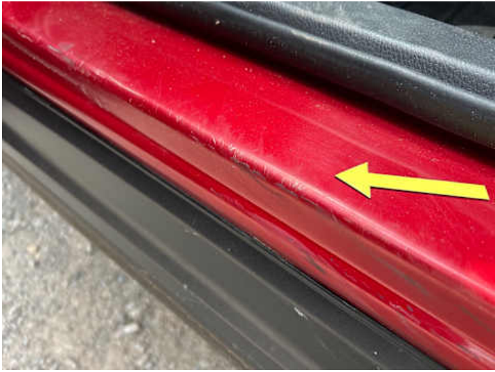
Schweller links (Lackschaden)
