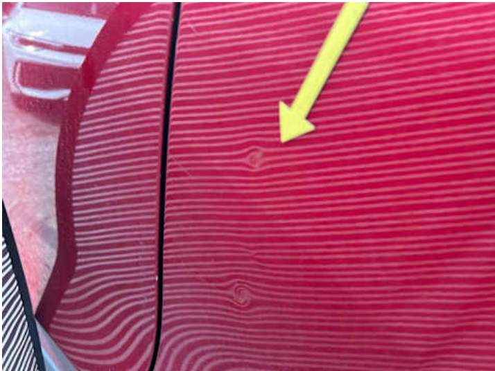
Türe hinten links (Lackschaden, Delle)
