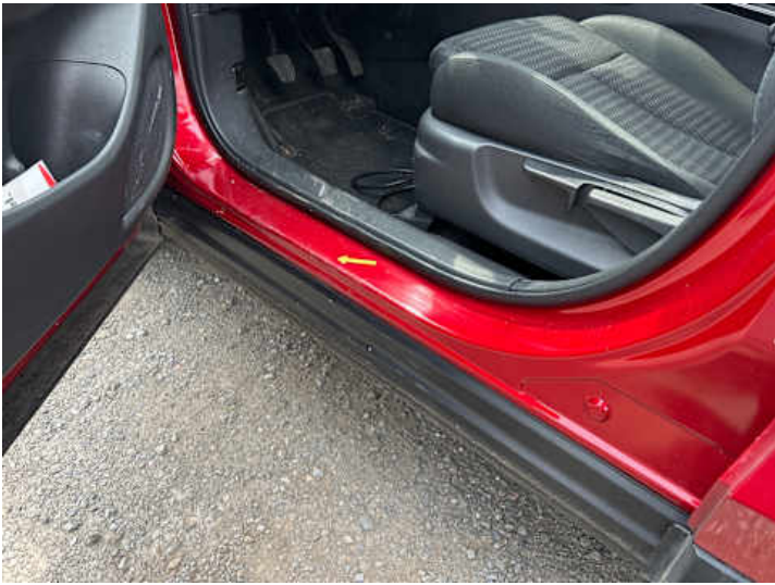
Schweller links (Lackschaden)
