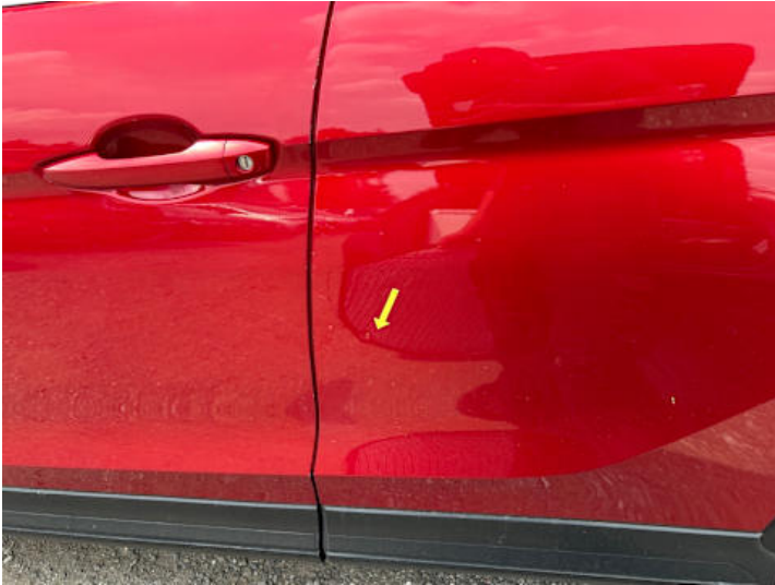
Türe hinten links (Lackschaden, Delle)
