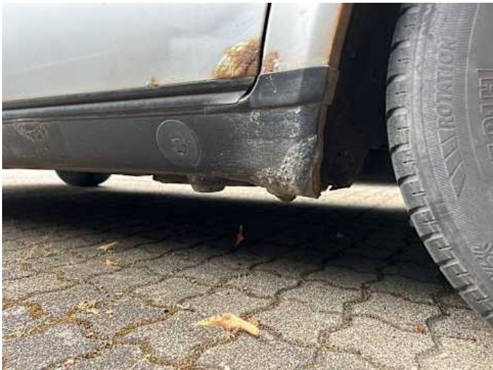
Schweller links (Rost)
