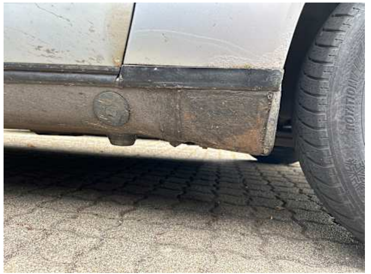
Schweller rechts (Rost)
