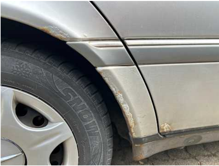
Seitenteil hinten rechts (Rost)
