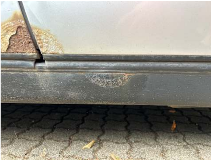
Schweller links (Rost)
