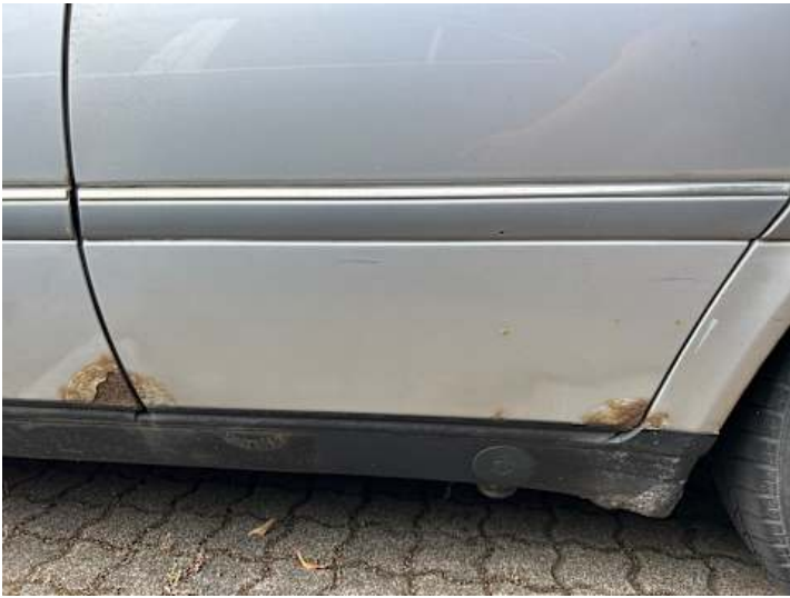
Türe hinten links (Rost)
