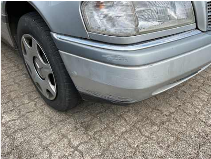
Stoßstange vorne (Unsachgemäß instand gesetzt)
