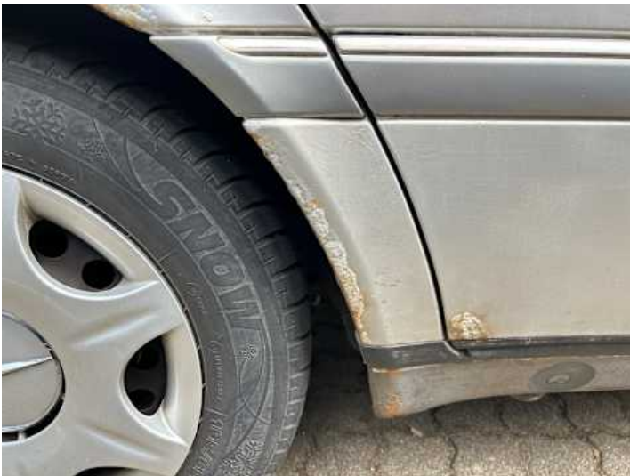
Seitenteil hinten rechts (Unsachgemäß instand gesetzt)
