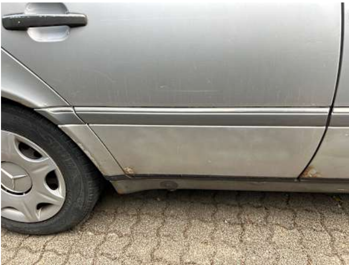
Türe hinten rechts (Unsachgemäß instand gesetzt)
