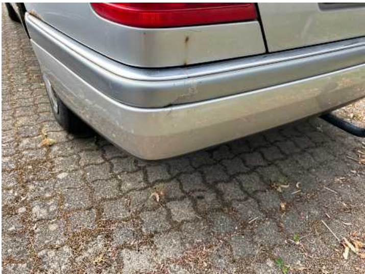
Stoßstange hinten (Kratzer, Delle, Riss/Bruch)
