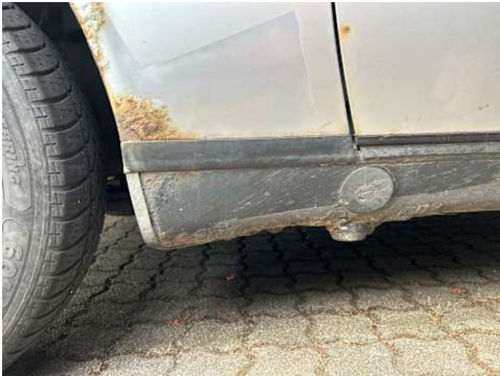
Schweller links (Rost)
