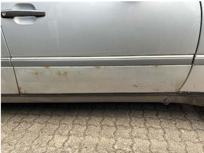
Beifahrertür (Unsachgemäß instand gesetzt)
