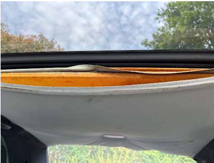
Innenraum (Anderer Schaden): Dachhimmel hängt durch
