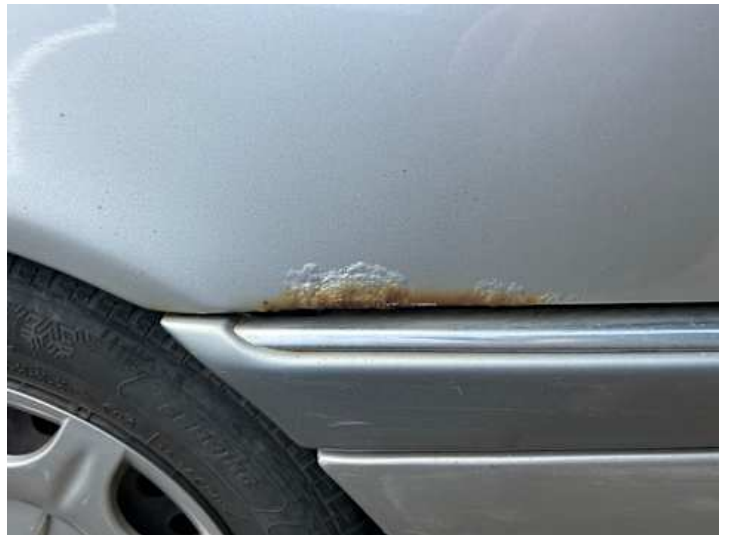
Seitenteil hinten links (Rost)
