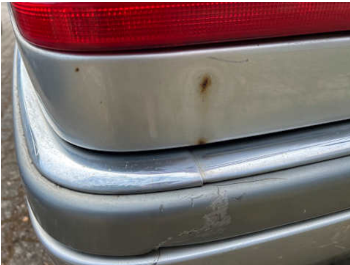
Seitenteil hinten links (Rost)
