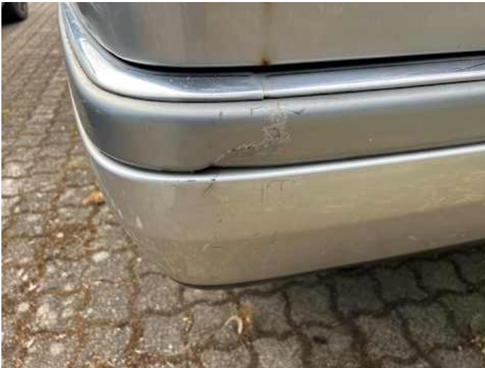
Stoßstange hinten (Kratzer, Delle, Riss/Bruch)
