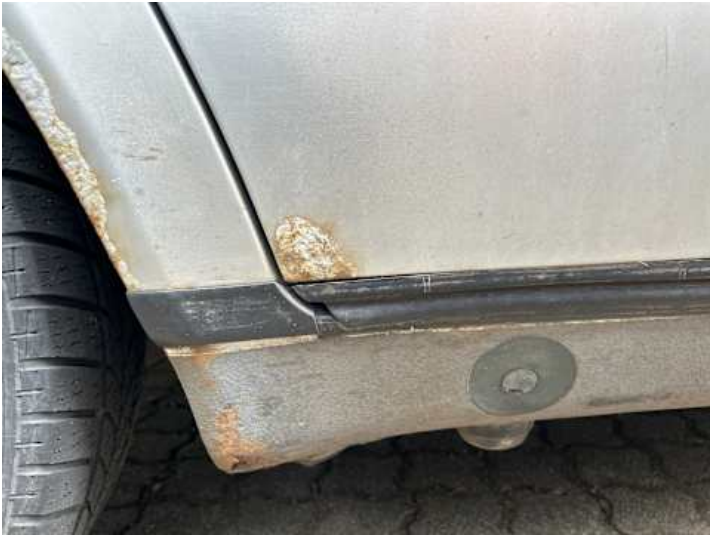
Türe hinten rechts (Rost)
