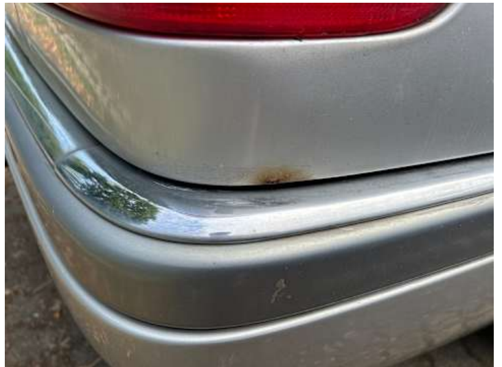
Seitenteil hinten rechts (Rost)
