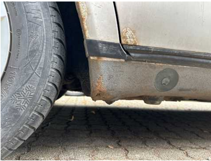
Schweller rechts (Rost)
