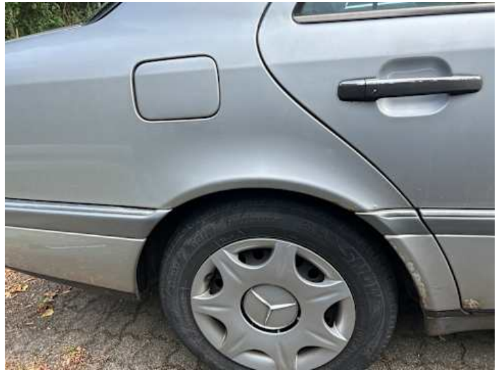
Seitenteil hinten rechts (Unsachgemäß instand gesetzt)
