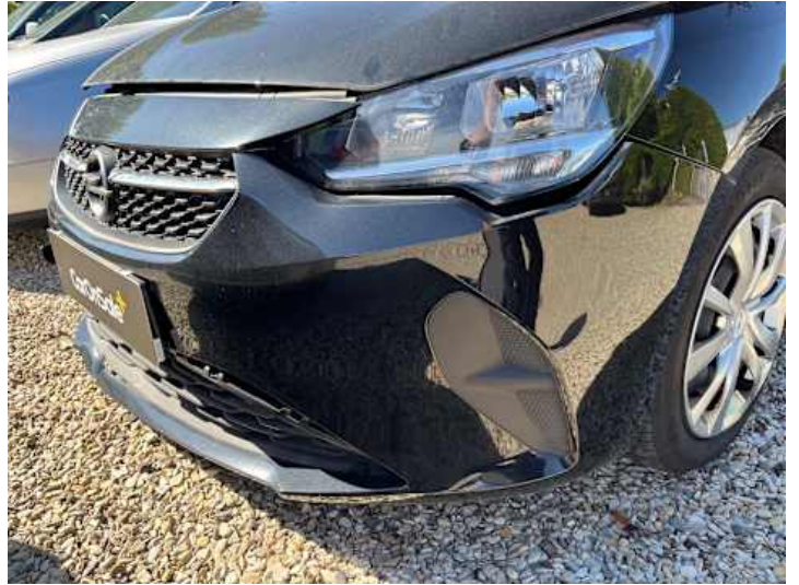
Stoßstange vorne (Verformung, Riss/Bruch)
