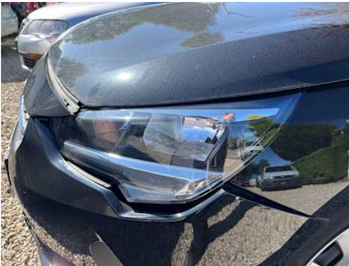
Scheinwerfer (links) (Riss/Bruch)
