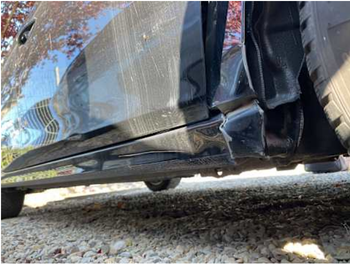
Schweller rechts (Verformung, Riss/Bruch)
