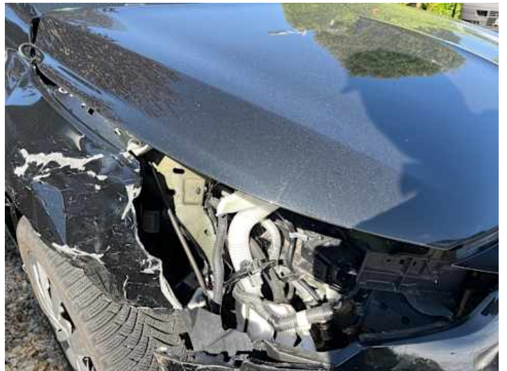
Motorhaube (Verformung, Spaltmaße ungenau)
