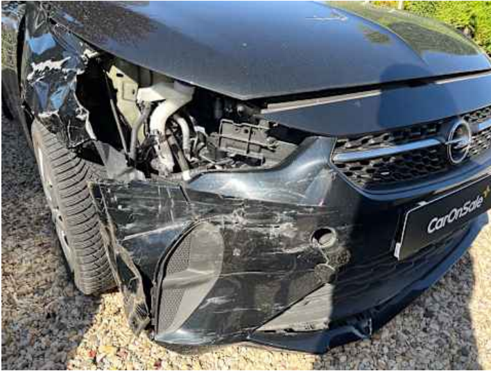
Stoßstange vorne (Verformung, Riss/Bruch)
