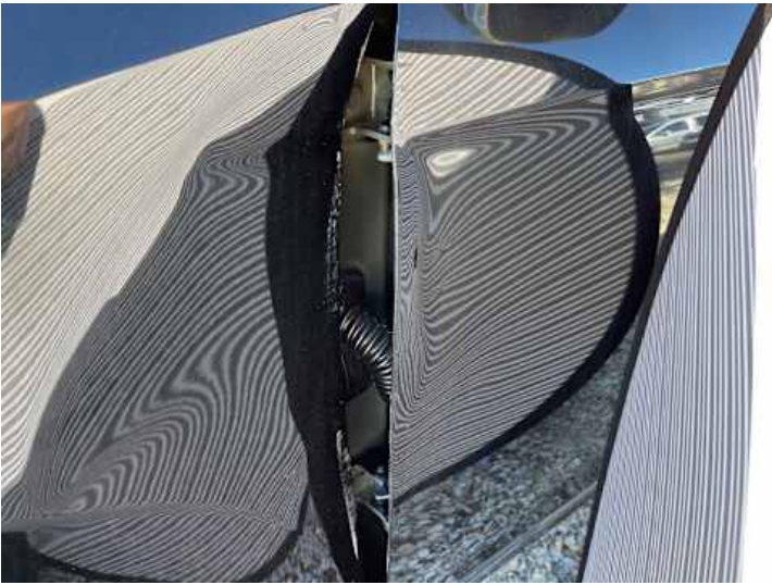
Fahrtür (Verformung, Kratzer)
