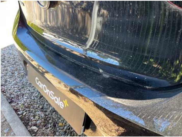
Stoßstange hinten (Kratzer)
