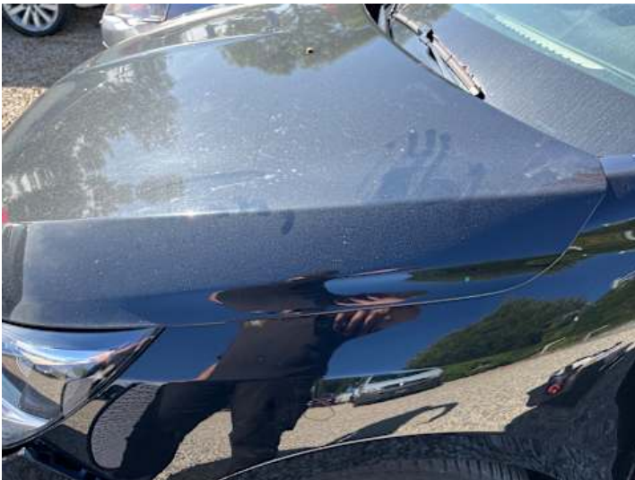
Motorhaube (Verformung, Spaltmaße ungenau)
