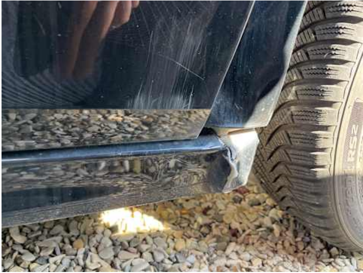
Schweller rechts (Verformung, Riss/Bruch)
