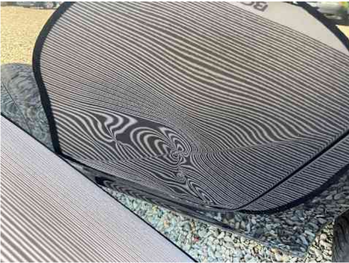
Türe hinten links (Verformung, Kratzer)
