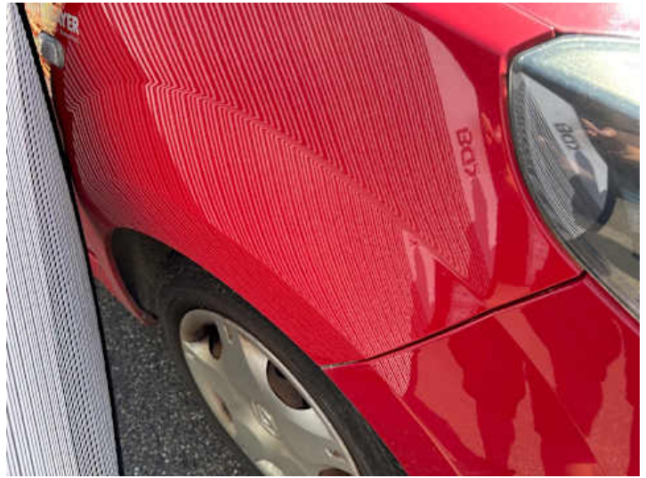
Kotflügel vorne rechts (Unsachgemäß instand gesetzt)
