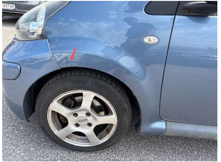
Kotflügel vorne links (Rost)
