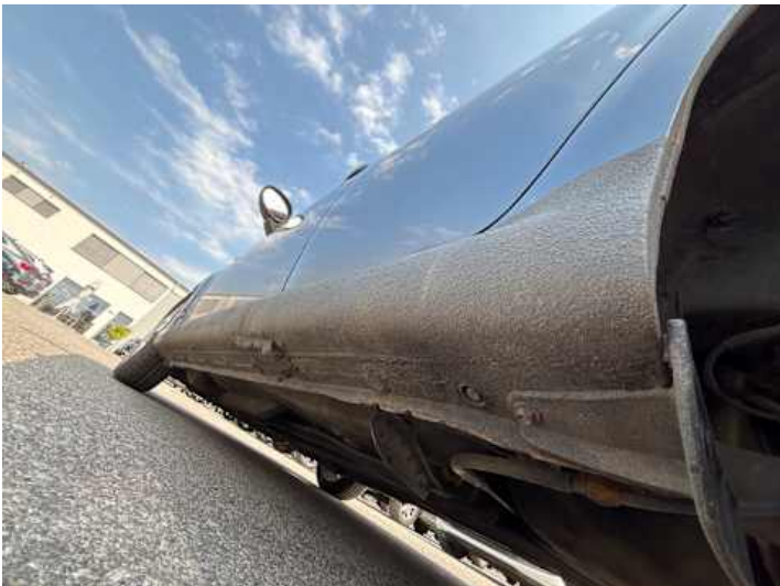
Schweller links (Unsachgemäß instand gesetzt)
