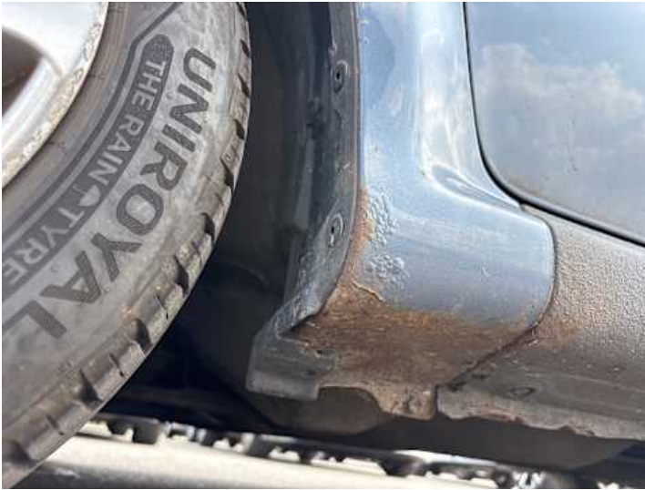
Kotflügel vorne links (Rost)
