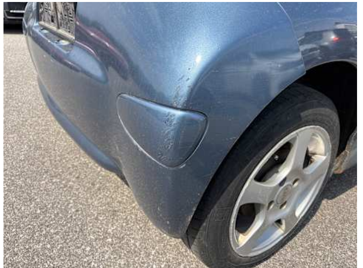
Stoßstange hinten (Kratzer, Lackschaden)
