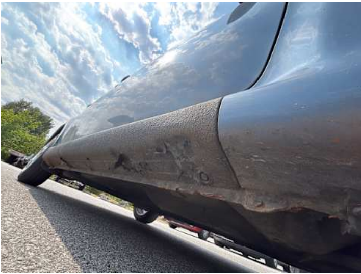
Schweller rechts (Verformung, Rost, Unsachgemäß instand gesetzt)
