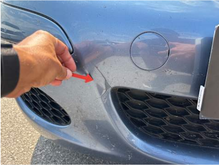
Stoßstange vorne (Riss/Bruch)
