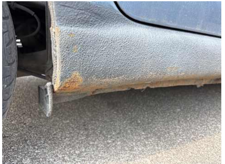
Schweller rechts (Verformung, Rost, Unsachgemäß instand gesetzt)
