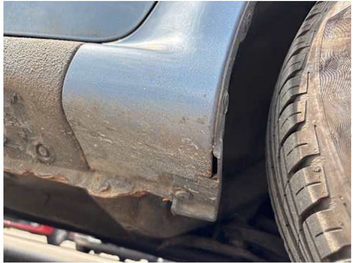
Kotflügel vorne rechts (Rost)
