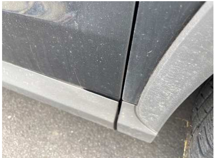
Beifahrtür (Spaltmaße ungenau)
