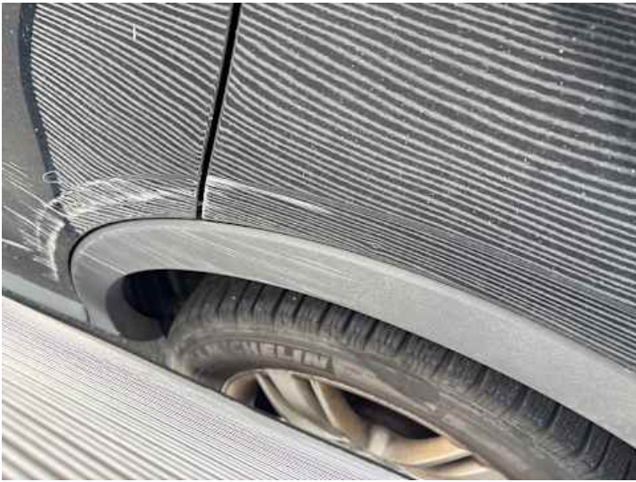
Seitenteil hinten links (Verformung, Kratzer)
