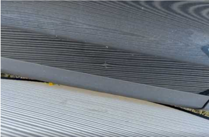
Türe hinten rechts (Delle, Lackschaden)
