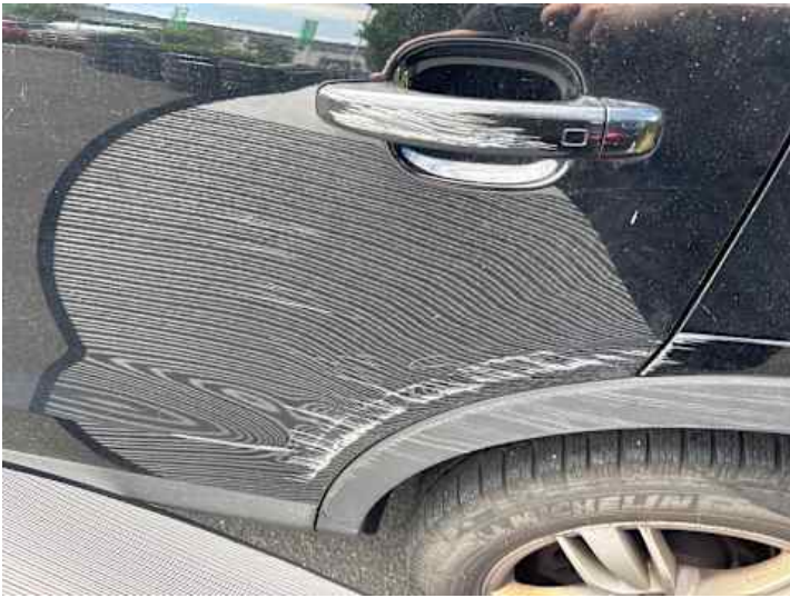
Türe hinten links (Verformung, Kratzer)
