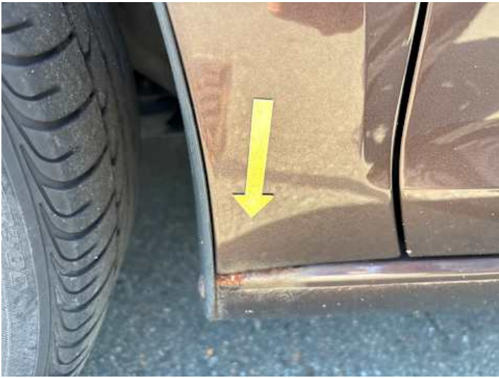
Kotflügel vorne links (Rost)
