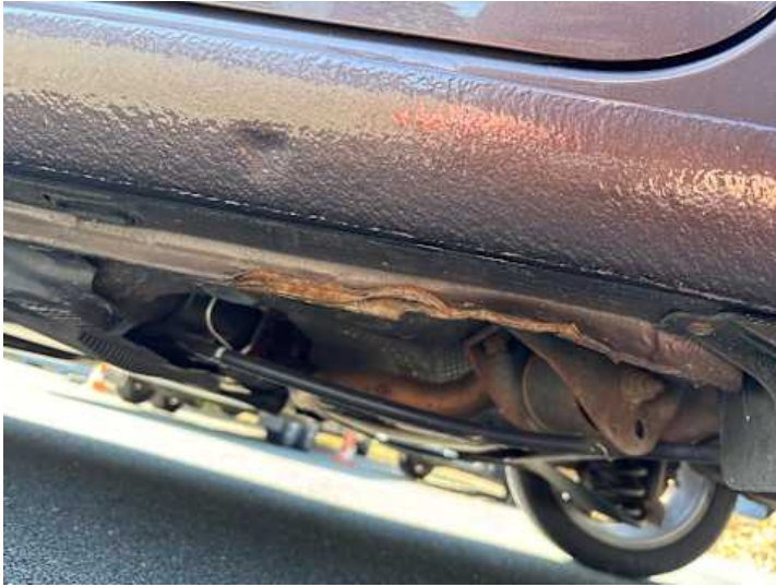
Schweller links (Rost, Verformung)
