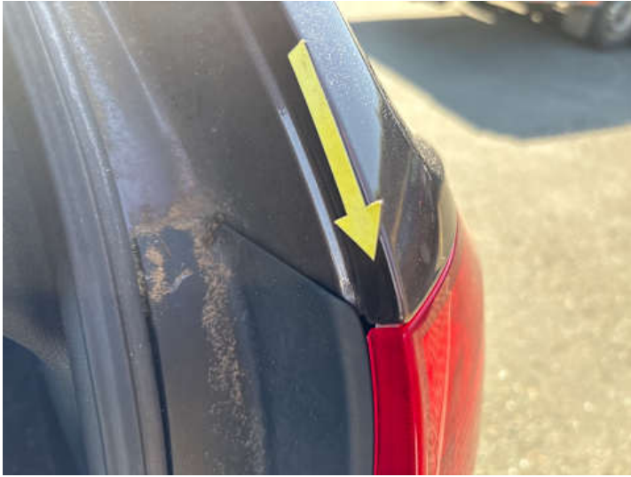
Seitenteil hinten rechts (Lackschaden, Rost)
