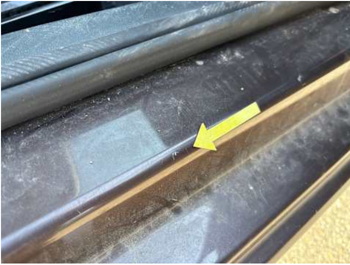
Schweller rechts (Lackschaden)
