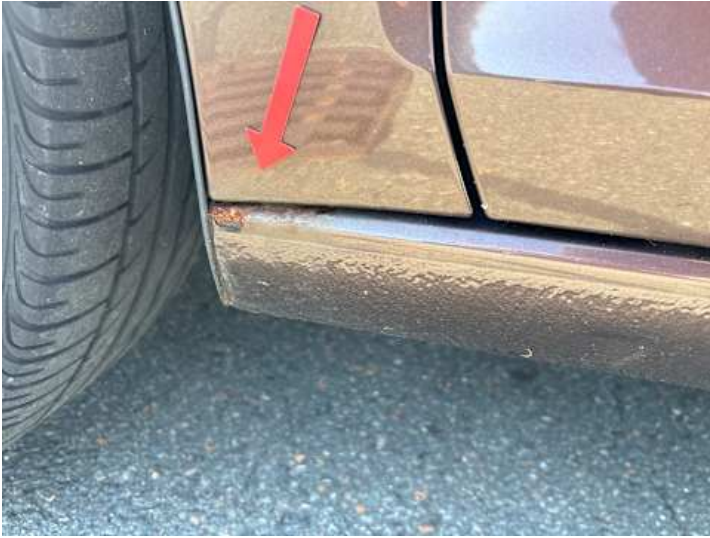
Schweller links (Rost)
