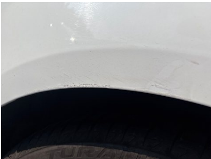
Seitenteil hinten rechts (Rost, Unsachgemäß instand gesetzt)
