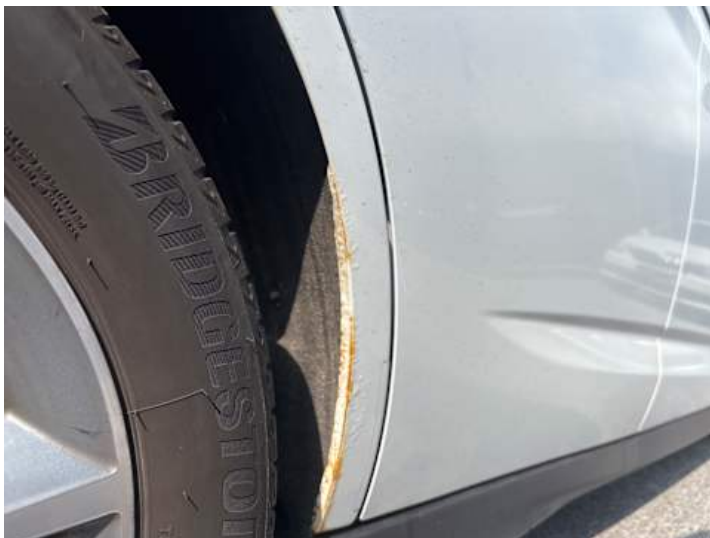
Seitenteil hinten rechts (Rost)
