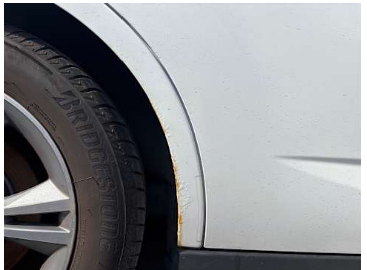
Seitenteil hinten rechts (Rost)
