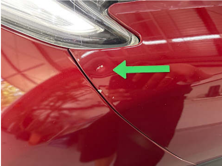
Kotflügel vorne links (Kratzer, Delle)
