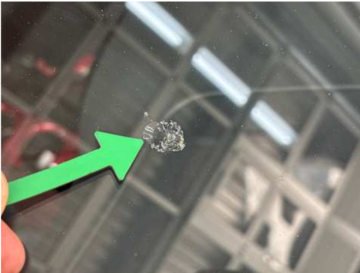
Windschutzscheibe (Steinschlag, Riss/Bruch)
