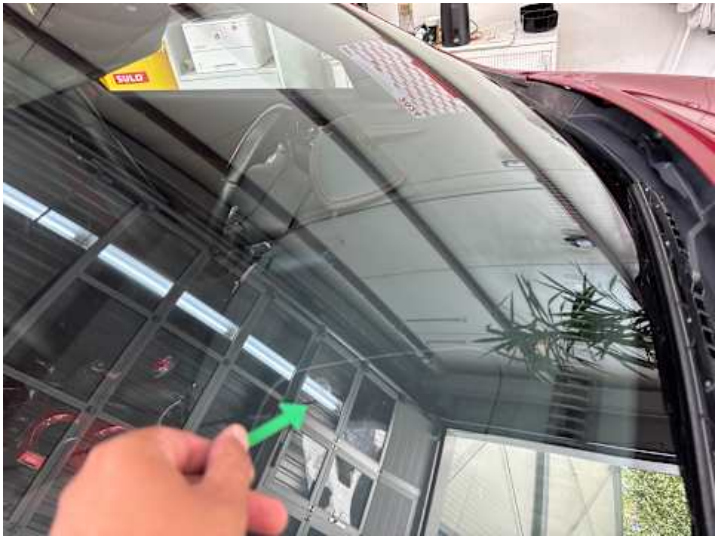
Windschutzscheibe (Steinschlag, Riss/Bruch)
