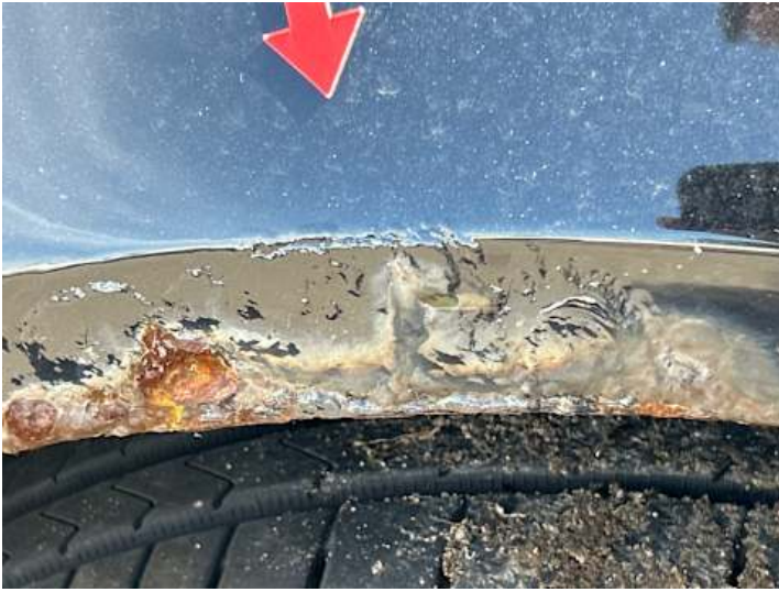
Kotflügel vorne links (Rost)
