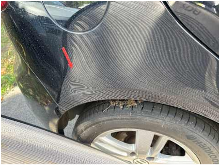
Seitenteil hinten rechts (Verformung, Delle, Kratzer)
