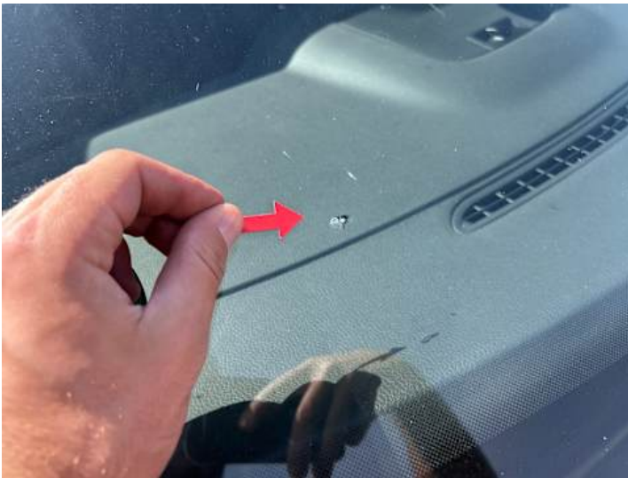
Windschutzscheibe (Riss/Bruch, Steinschlag)
