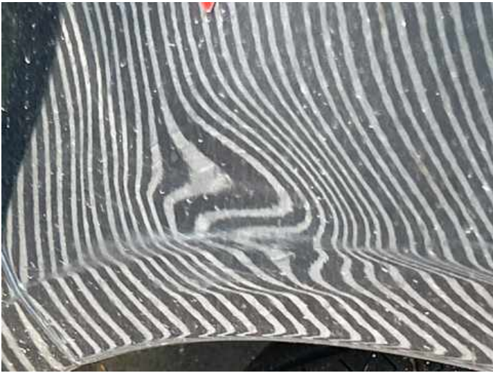
Seitenteil hinten rechts (Verformung, Delle, Kratzer)
