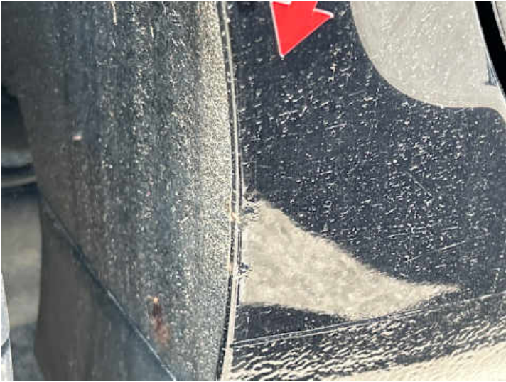
Seitenteil hinten rechts (Rost)
