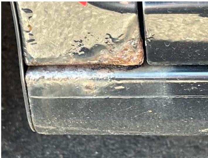
Kotflügel vorne links (Rost)
