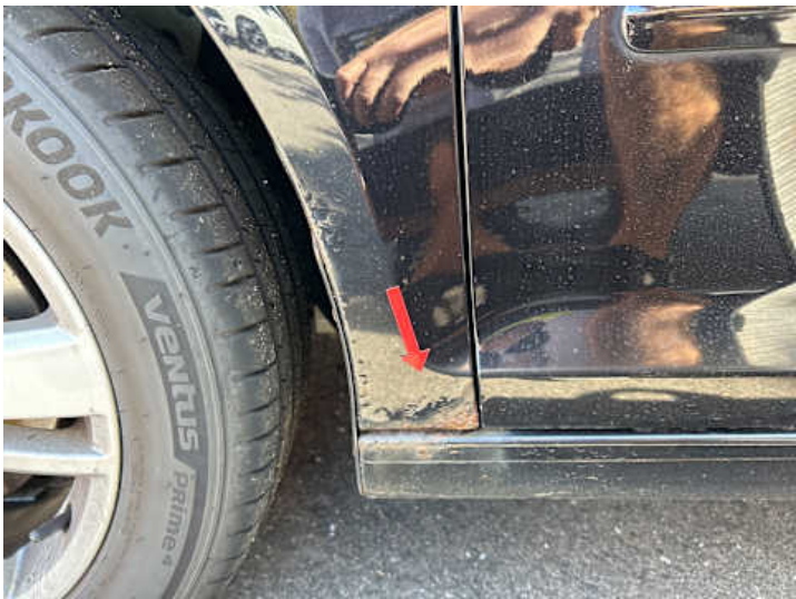
Kotflügel vorne links (Rost)
