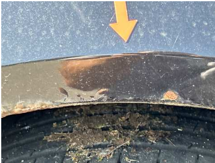
Kotflügel vorne rechts (Rost)
