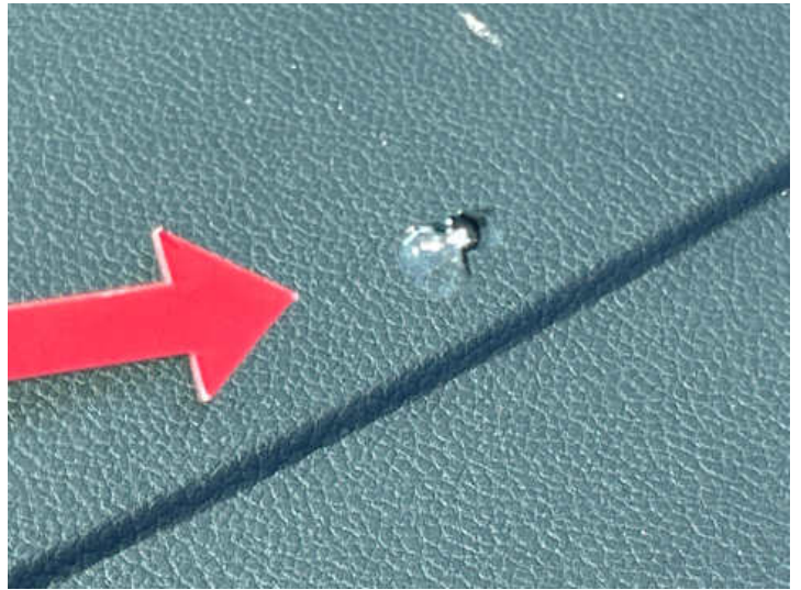
Windschutzscheibe (Riss/Bruch, Steinschlag)
