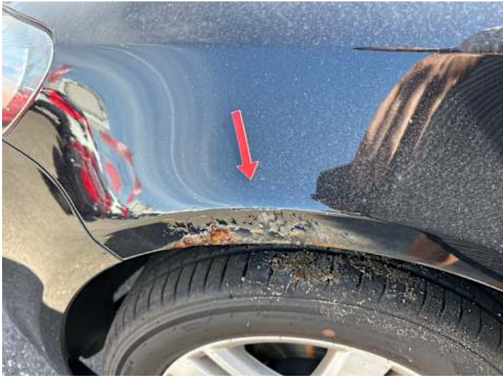
Kotflügel vorne links (Rost)
