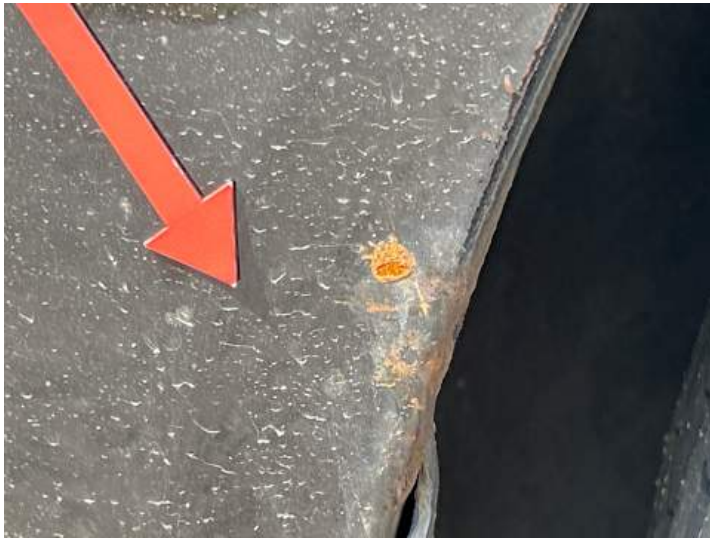
Kotflügel vorne rechts (Rost)
