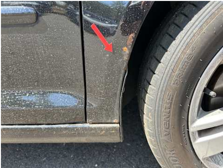
Kotflügel vorne rechts (Rost)
