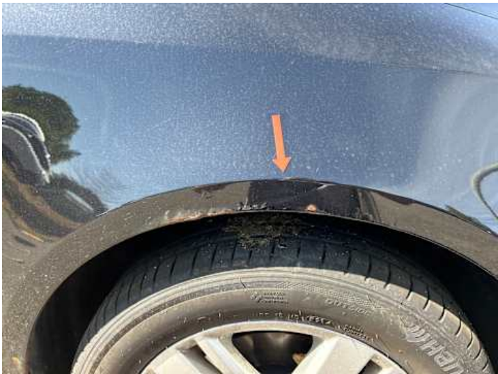
Kotflügel vorne rechts (Rost)
