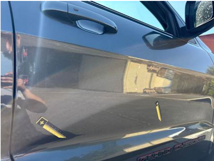
Beifahrertür (Kratzer, Anderer Schaden): Kratzer über der gesamten Tür
