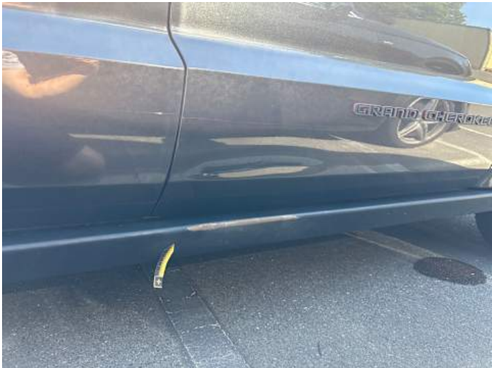
Schweller rechts (Lackschaden, Rost, Verformung)
