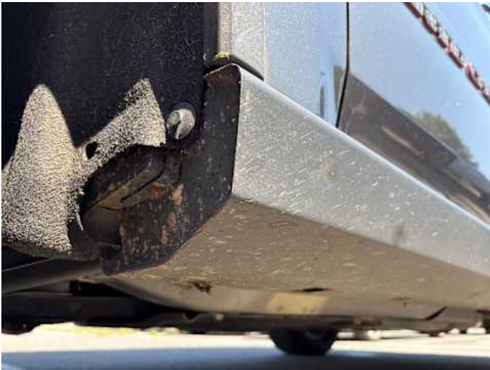
Schweller links (Rost, Lackschaden)
