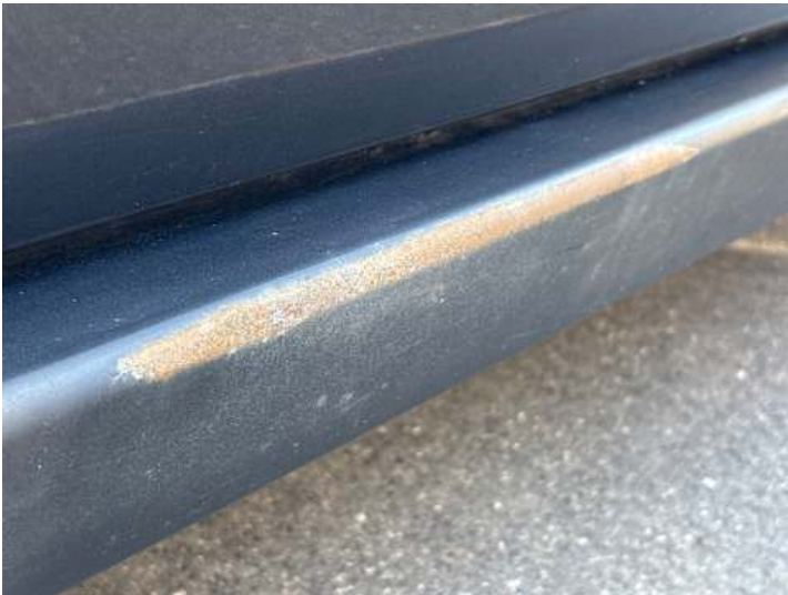
Schweller rechts (Lackschaden, Rost, Verformung)
