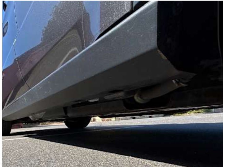
Schweller links (Rost, Lackschaden)
