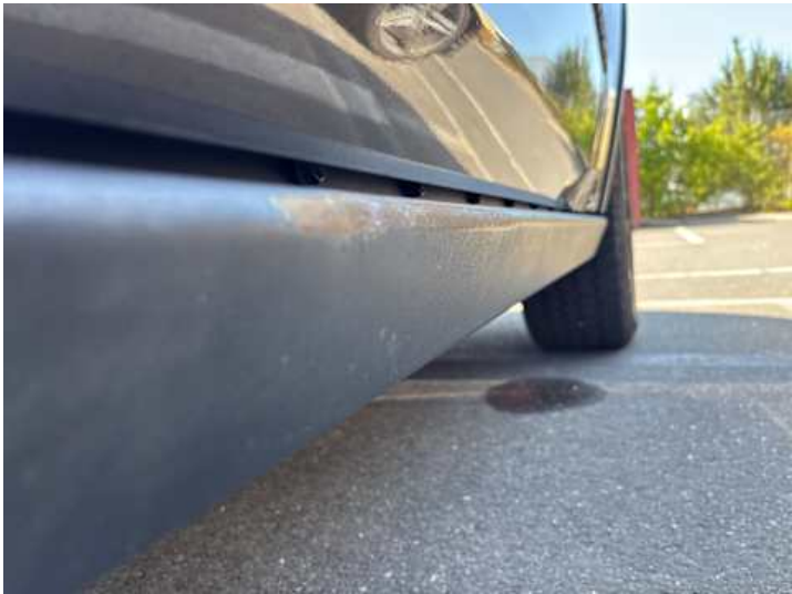
Schweller rechts (Lackschaden, Rost, Verformung)
