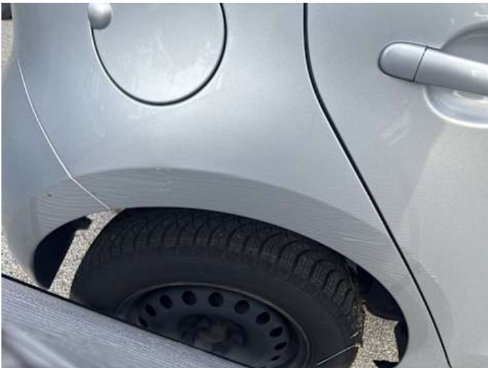
Seitenteil hinten rechts (Verformung, Kratzer)
