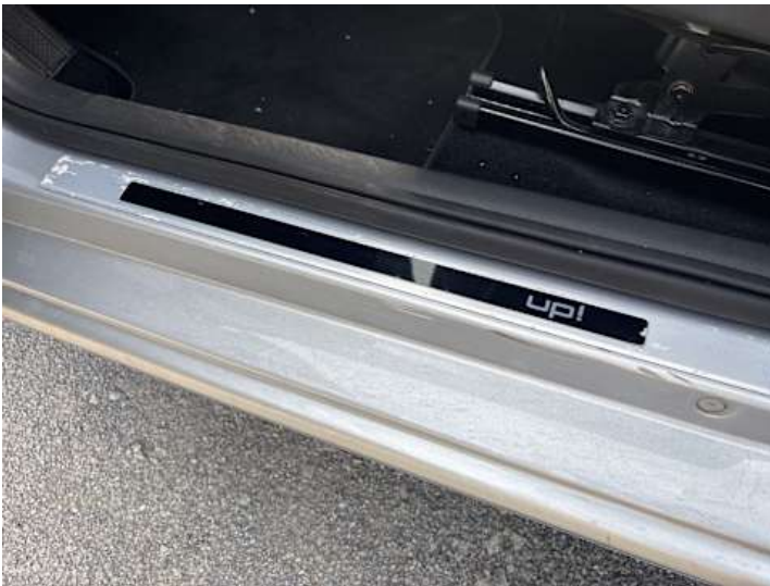
Schweller links (Kratzer)
