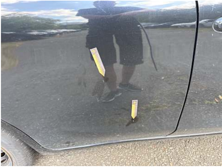
Türe hinten rechts (Kratzer)
