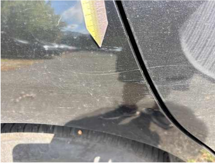
Seitenteil hinten rechts (Kratzer, Delle, Verformung)
