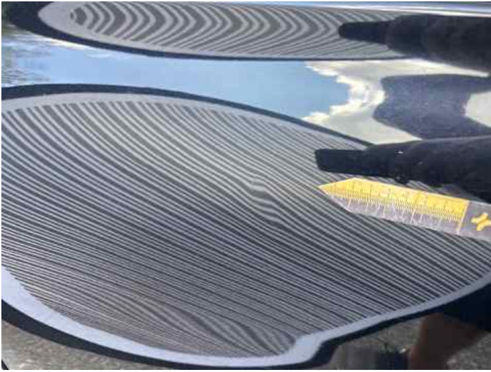
Türe hinten rechts (Delle, Kratzer)
