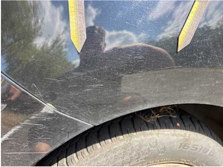
Seitenteil hinten rechts (Kratzer, Delle, Verformung)
