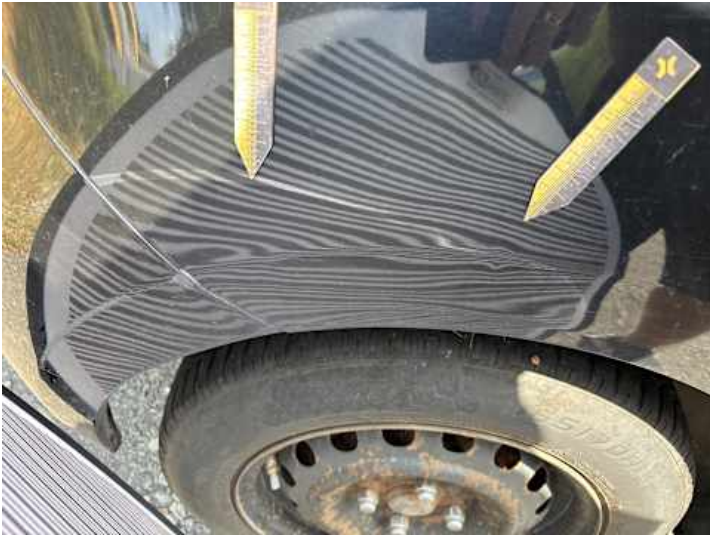
Seitenteil hinten rechts (Kratzer, Delle, Verformung)
