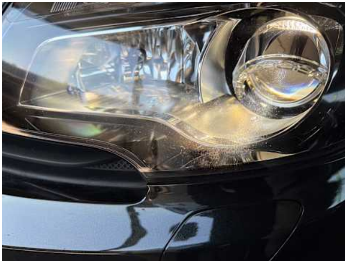
Scheinwerfer (links) (Steinschlag, Anderer Schaden): Plastickabdeckung abgefallen
