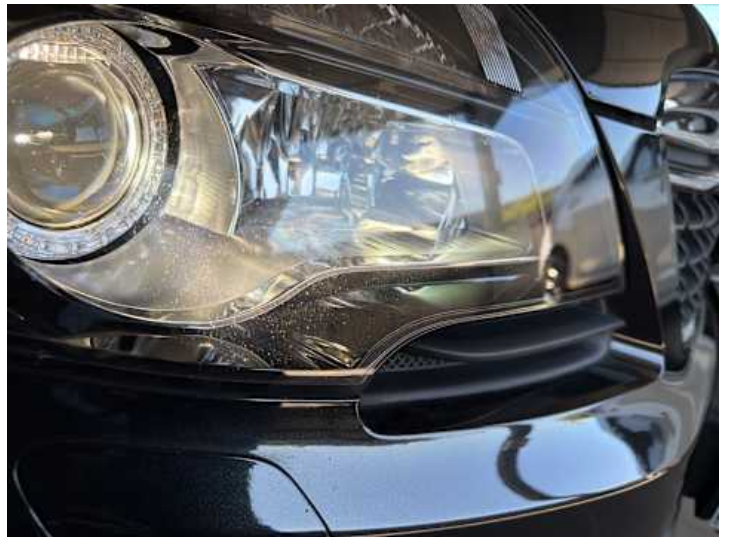
Scheinwerfer (rechts) (Steinschlag)
