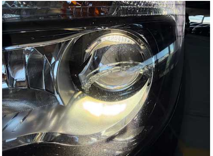
Scheinwerfer (links) (Steinschlag, Anderer Schaden): Plastickabdeckung abgefallen
