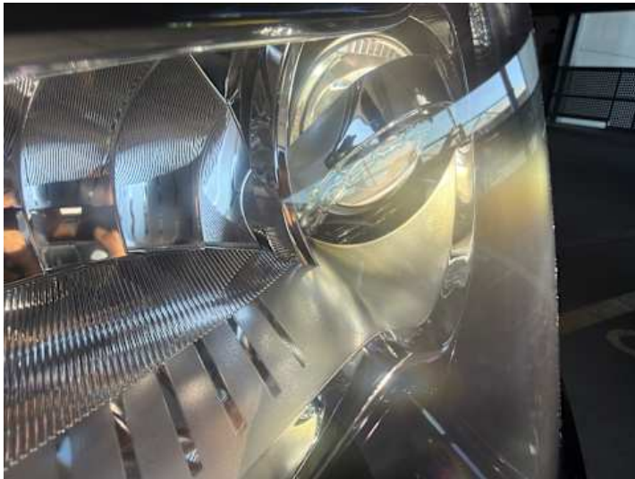
Scheinwerfer (links) (Steinschlag, Anderer Schaden): Plastickabdeckung abgefallen
