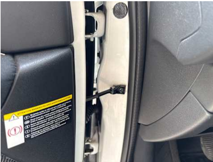
Fahrtür (Anderer Schaden): Türscharnier knackt
