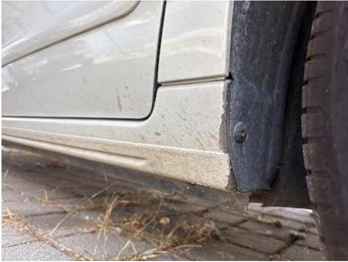
Schweller rechts (Kratzer, Rost)
