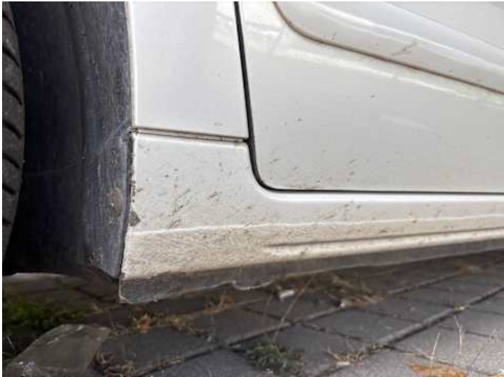
Schweller links (Kratzer)
