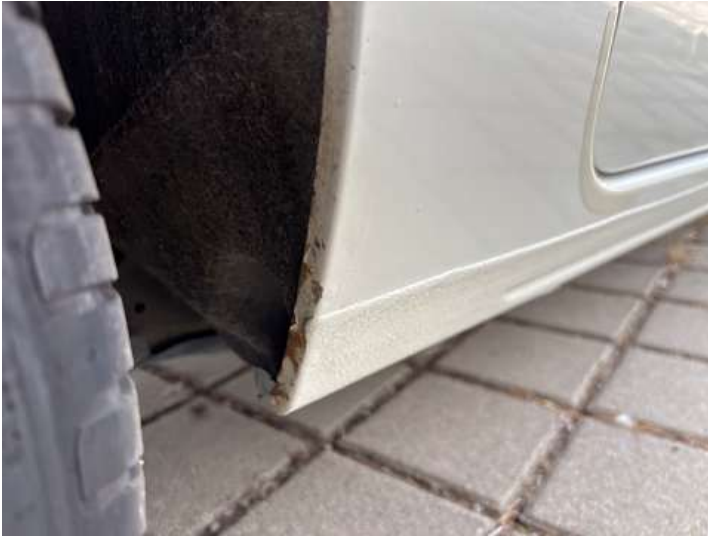
Schweller rechts (Kratzer, Rost)
