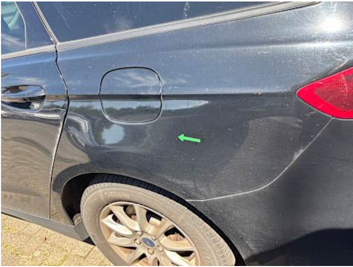
Seitenteil hinten links (Unsachgemäß instand gesetzt)
