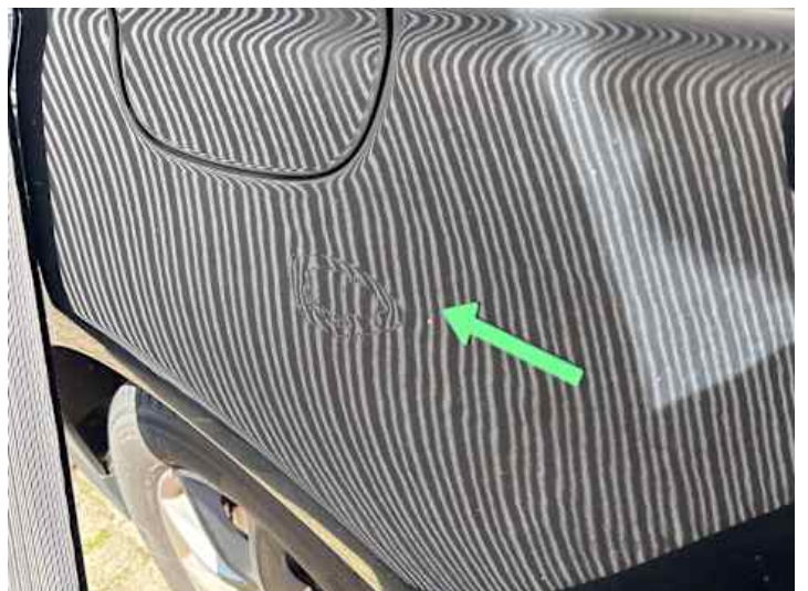
Seitenteil hinten links (Unsachgemäß instand gesetzt)
