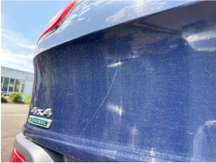
Heckklappe (Kratzer, Lackschaden)
