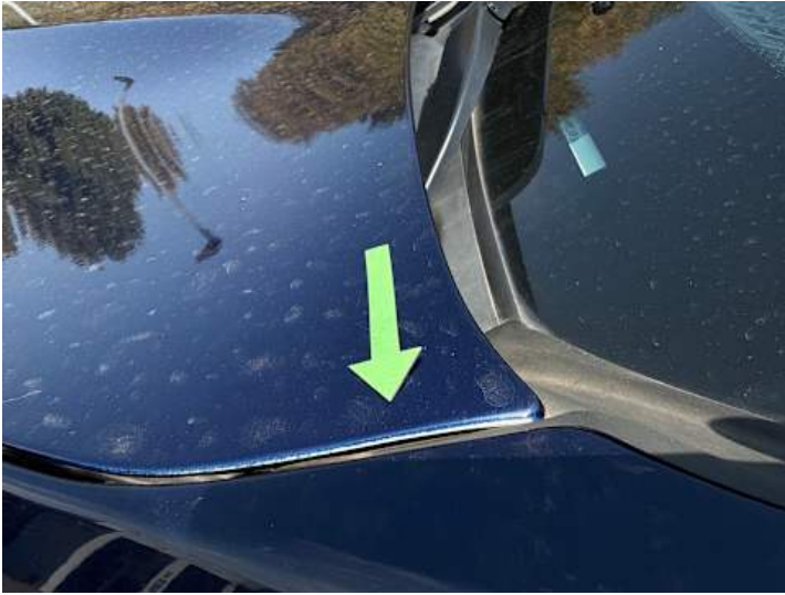
Motorhaube (Unsachgemäß instand gesetzt)
