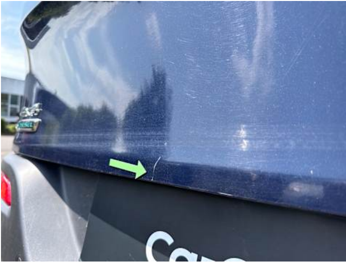
Heckklappe (Kratzer, Lackschaden)
