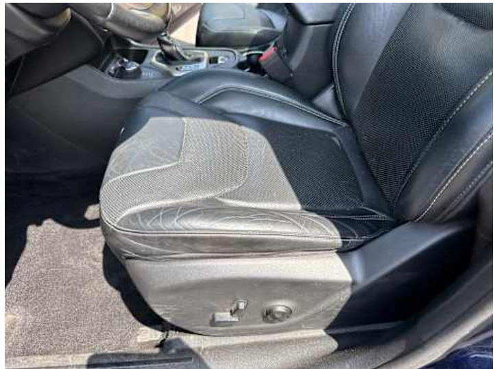
Innenraum (Verschleiß, Verschmutzung, Kratzer)
