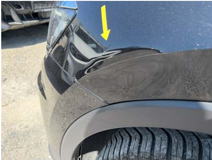
Kotflügel vorne links (Kratzer, Verformung)
