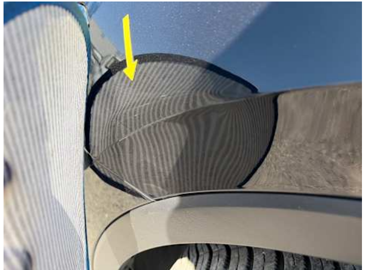
Kotflügel vorne links (Kratzer, Verformung)
