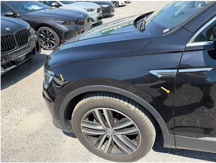
Kotflügel vorne links (Kratzer, Verformung)
