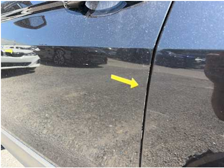
Fahrtür (Kratzer, Delle)
