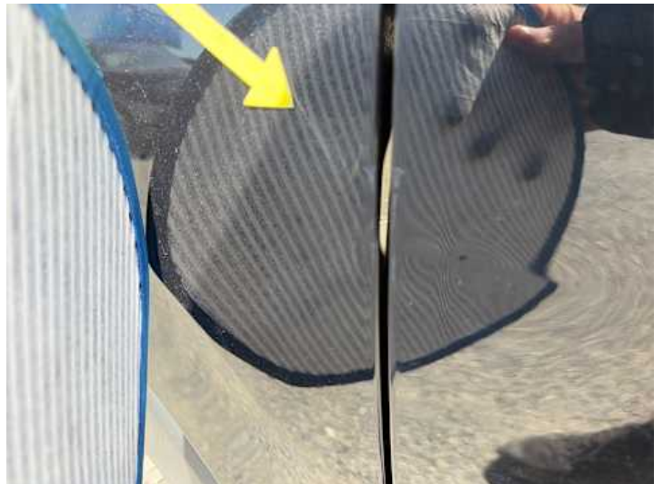
Kotflügel vorne links (Kratzer, Verformung)
