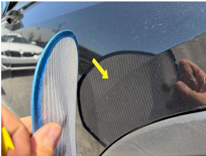
Türe hinten links (Kratzer, Delle)
