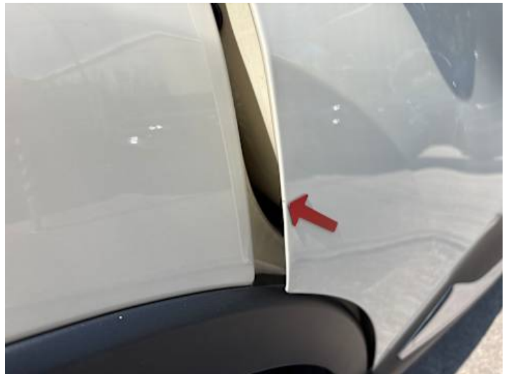
Türe hinten rechts (Lackschaden)
