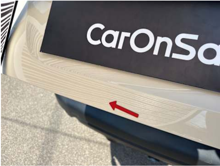
Heckklappe (Delle, Kratzer)
