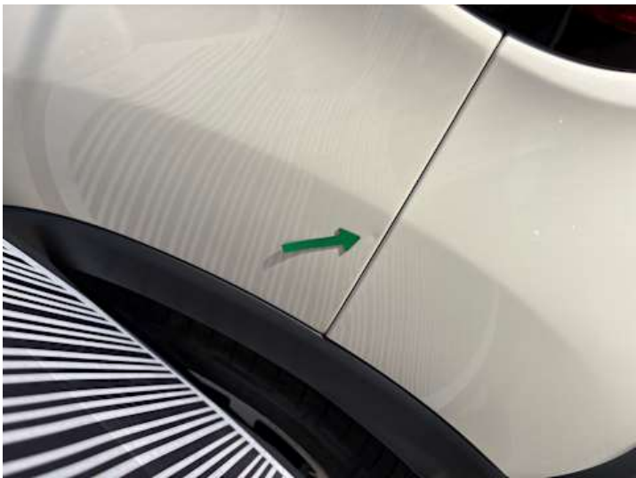
Seitenteil hinten links (Delle)
