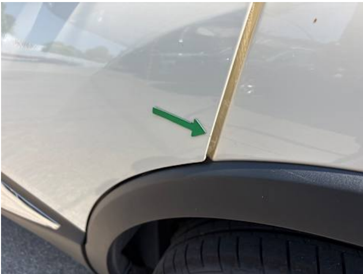
Türe hinten links (Lackschaden)
